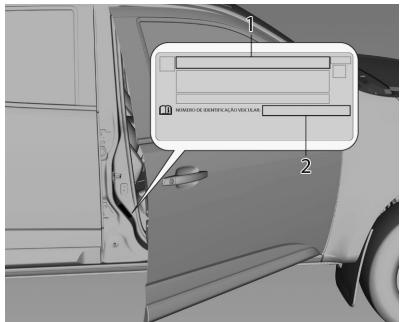
La placa de identificación está visible en el bastidor cuando se abre la puerta del pasajero, como se muestra en la ilustración de abajo.
