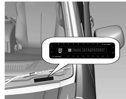
El número de identificación del vehículo está grabado en el tablero de instrumentos, visible a través del parabrisas.
