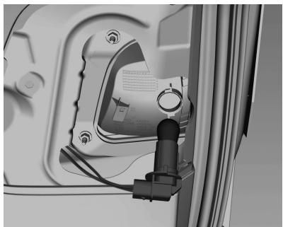
4. Extraiga la lámpara del portalámpara. Presione levemente la lámpara en el casquillo para insertarla.
