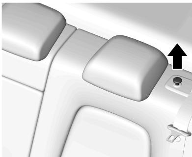
3. Tire de la palanca de la parte superior del respaldo para desbloquearlo.
