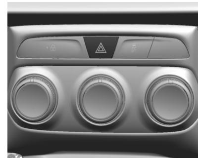
⚠: Pulse ⚠ para hacer destellar las luces de giro delanteras, traseras y laterales. Presiónelo nuevamente para apagar las balizas.
