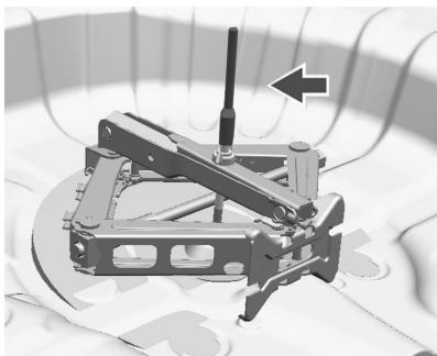
4. Instale la varilla de extensión antes de colocar la rueda de tamaño normal dañada en la cavidad para la rueda de auxilio.
