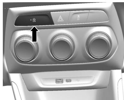
La luz testigo integrada al interruptor del bloqueo de las puertas indica el estado del sistema:
