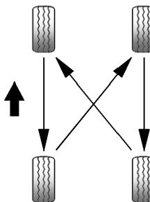
Las fuerzas que actúan sobre los neumáticos delanteros y traseros son diferentes, por eso se desgastan de forma diferente dependiendo de varios factores, como la superficie de la calzada, la forma de conducir, la alineación de la suspensión, el balanceo de las ruedas, la presión de los neumáticos, etc.
