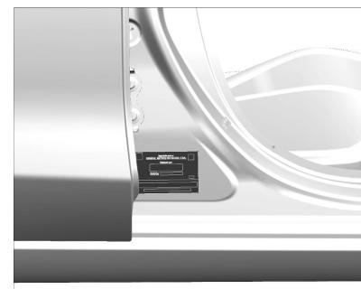
La placa de identificación del vehículo está situada en el pilar de la puerta delantera derecha.
