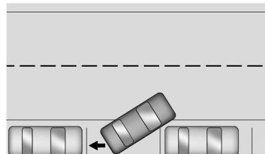
Después de pasar completamente esta ranura, el APA le indica al conductor detener el vehículo y cambiar a R (marcha atrás) para activar la conducción automática. El volante vibra brevemente para recordarle que quite las manos del mismo. Mire a los alrededores y continúe frenando o acelerando según sea necesario, y esté listo para frenar para evitar vehículos, peatones y objetos.
