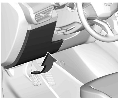
La caja de fusibles del tablero de instrumentos está situada en la parte inferior del tablero de instrumentos del lado del conductor.
