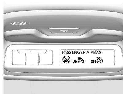
Siempre que el testigo de control **ON**  esté encendido, los sistemas de airbag del asiento del acompañante se inflarán en caso de choque.
