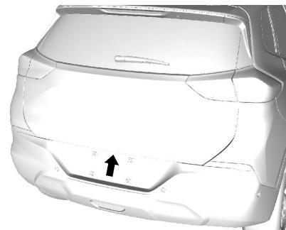
Para abrir la compuerta levadiza, el vehículo debe estar apagado o detenido, con la palanca de cambios en P (Estacionamiento), si está equipado.
