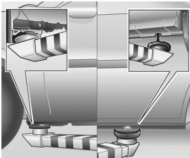
La ubicación de los puntos de apoyo de un elevador o gato deben situarse solo en los lugares indicados en las ilustraciones, en las partes delantera y trasera, en las zonas entre el lugar para la instalación del gato y los alojamientos de las ruedas.
