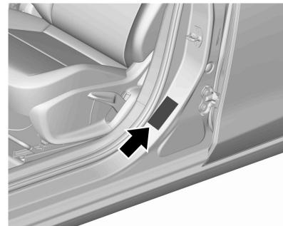
La etiqueta de la presión de los neumáticos está situada en el montante de la puerta delantera izquierda.
