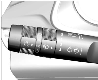
Para señalizar un giro, mueva la palanca hacia arriba o hacia abajo, hasta el tope.
