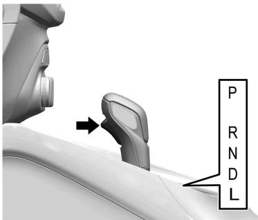
**P:** Esta posición bloquea las ruedas de tracción. Use P (Estacionamiento) al arrancar el vehículo ya que el vehículo no se puede mover fácilmente.
