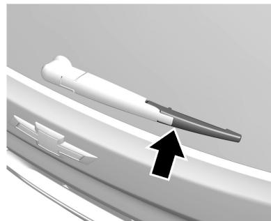
Levante el brazo del limpiaparabrisas. Empuje la escobilla hacia abajo, con un leve ángulo en relación al brazo, hasta que se desenclave.
