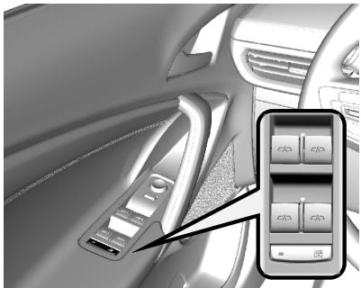
Pulse el interruptor
