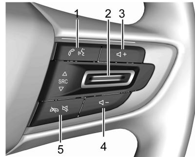
**1 = ⚡ / ⌂ :** En vehículos con Bluetooth u OnStar, pulse para interactuar con estos sistemas y para aceptar una llamada entrante.
