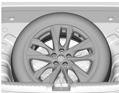
5. Coloque el neumático desinflado en el baúl. Primero empuje el neumático desinflado sobre el piso trasero.
