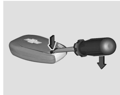
1. Inserte un destornillador plano en la ranura y separe la cubierta trasera de la unidad del control remoto.
