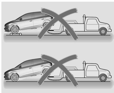
El remolque con dos de las ruedas levantadas del piso no es apropiado para este vehículo.
