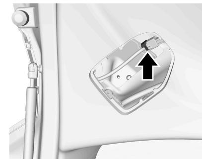
4. Desenchufe el conjunto de la luz trasera del conector y extraiga el conjunto de la luz trasera del portón trasero.
