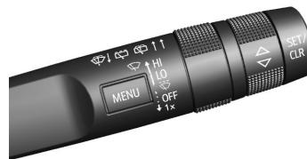
Empuje la palanca hacia adelante hasta la primera posición. El limpialuneta comenzará a barrer. Para detener el movimiento, coloque la palanca en la posición inicial.
