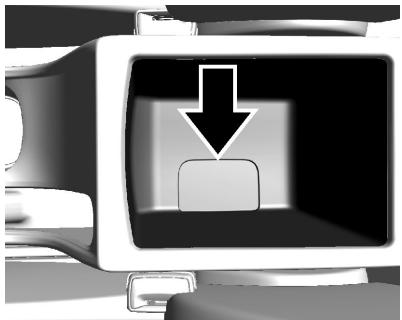
Coloque la llave no remota o la llave electrónica en la cavidad de la consola central, debajo del apoyabrazos. En la figura se muestra la ubicación correcta.
