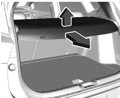
Para quitar la cubierta del vehículo, desate la cuerda y retire la cubierta de la ranura. Para volver a instalarla, coloque cada extremo de la cubierta en las ranuras y deslicela hasta el final de las ranuras a ambos lados. Asegúrese de que ambos lados estén correctamente instalados conforme a la imagen a continuación. Ate la cuerda a la compuerta levadiza.
