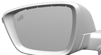
Cuando la velocidad del vehículo supera los 10 km/h, se activa el sistema de alerta del punto ciego lateral. Cuando la velocidad del vehículo es superior a los 140 km/h, se desactiva el sistema y se atenúan las luces indicadoras de los espejos derecho e izquierdo. En este punto, si se reduce la velocidad del vehículo, se apagan las luces indicadoras en los espejos. Si se detecta un vehículo en el punto ciego en este momento, se enciende la luz indicadora del espejo correspondiente.
