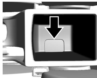
1. Coloque la llave no remota o el transmisor dentro del apoyabrazos, como se muestra en la figura.
