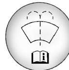
Abra el tapón con que tiene el símbolo del lavaparabrisas. Agregue líquido del lavaparabrisas hasta que se llene el tanque. Vea la ubicación del depósito en *Vista del compartimento del motor (Inyección directa)* ▷ 197.
