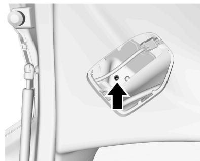
3. Retire el tornillo que sujetá el conjunto de la luz trasera al portón trasero.
