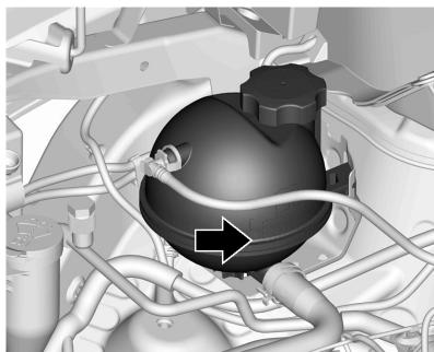
El tanque de compensación del refrigerante está ubicado en el compartimiento del motor, del lado del acompañante. Consulte *Vista del compartimiento del motor (Inyección directa)* ↳ 197.
