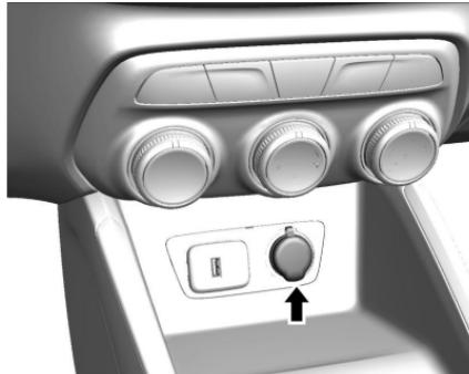
Los tomacorrientes para accesorios se pueden usar para enchufar equipos eléctricos, tales como teléfonos móviles, cargadores de GPS o cualquier otro dispositivo de 12 V que no exceda los 120 W.
