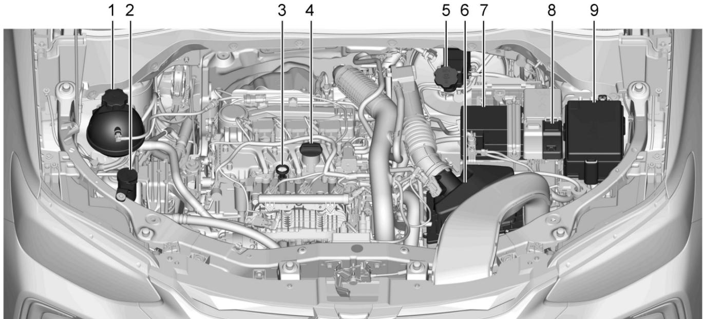
1. Depósito del refrigerante del motor.
