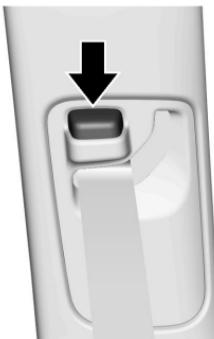
Presione el botón de desbloqueo y mueva el ajuste de seguridad a la posición deseada. El ajuste se puede mover empujando el deslizador. Una vez que el ajuste esté en la posición deseada, trate de moverlo hacia abajo sin presionar el botón de desbloqueo para verificar que se ha trabado en la posición deseada.
