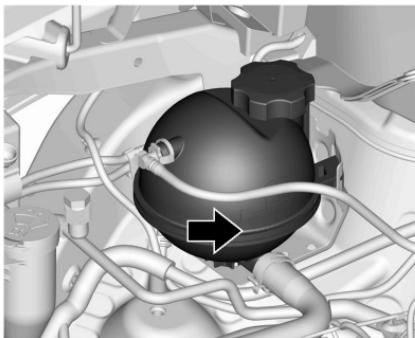
El tanque de compensación del refrigerante está ubicado en el compartimiento del motor, del lado del acompañante. Consulte *Vista del compartimento del motor* ▷ 169 *Vista del compartimento del motor (Inyección directa)* ▷ 171.
