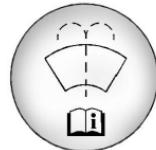
Abra el tapón con que tiene el símbolo del lavaparabrisas. Agregue líquido del lavaparabrisas hasta que se llene el tanque. Vea la ubicación del depósito en *Vista del compartimento del motor* ▷ 169 *Vista del compartimento del motor (Inyección directa)* ▷ 171.
