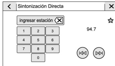
Acceda a Direct Tune (Sintonización directa) tocando el ícono **|||||** en la pantalla del infoentretenimiento para mostrar el teclado. Navegue hacia arriba y abajo por todas las frecuencias usando **◀◀** o **▶▶**. Use el teclado para ingresar directamente una emisora o canal. Cuando se ingresa una nueva emisora o canal, la información sobre dicha emisora o canal aparece del lado derecho. Esta
