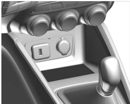
El encendido debe estar en contacto en la posición On/Run (Encendido/Marcha), ACC/ACCESORY (ACCESORIO), o debe estar activa la alimentación retenida para accesorios (RAP). La función de carga inalámbrica puede no indicar correctamente que está cargando cuando el vehículo está en RAP. Consulte *Alimentación de accesorios retenida (RAP)* ▷ 135.
