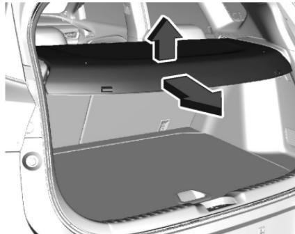
Para quitar la cubierta del vehículo, desate la cuerda y retire la cubierta de la ranura. Para volver a instalarla, coloque cada extremo de la cubierta en las ranuras y deslícela hasta el final de las ranuras a ambos lados. Asegúrese de que ambos lados estén correctamente instalados conforme a la imagen a continuación. Ate la cuerda a la compuerta levadiza.
