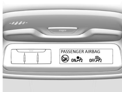
Siempre que el testigo de control **ON** esté encendido, los sistemas de airbag del asiento del acompañante se inflarán en caso de choque.
