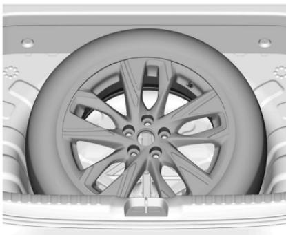
5. Coloque el neumático desinflado en el baúl. Primero empuje el neumático desinflado sobre el piso trasero.
