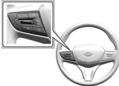
: Pulse para activar y desactivar el sistema de control de velocidad crucero. En el cuadro de instrumentos se enciende un indicador blanco cuando el crucero está activado.
