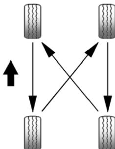
Las fuerzas que actúan sobre los neumáticos delanteros y traseros son diferentes, por eso se desgastan de forma diferente dependiendo de varios factores, como la superficie de la calzada, la forma de conducir, la alineación de la suspensión, el balanceo de las ruedas, la presión de los neumáticos, etc.
