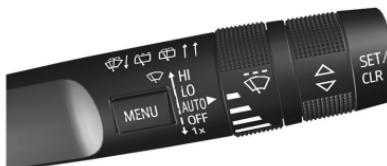
Con el encendido en contacto o en ACC/ACCESORY (ACCESORIO), mueva la palanca del limpiaparabrisas para seleccionar la velocidad del mismo.
