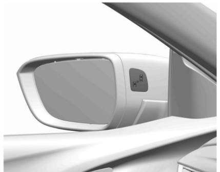
Cuando la velocidad del vehículo supera los 10 km/h, se activa el sistema de alerta del punto ciego lateral. Cuando la velocidad del vehículo es superior a los 140 km/h, se desactiva el sistema y se atenúan las luces indicadoras de los espejos derecho e izquierdo. En este punto, si se reduce la velocidad del vehículo, se apagan las luces indicadoras en los espejos. Si se detecta un vehículo en el punto ciego en este momento, se enciende la luz indicadora del espejo correspondiente.
