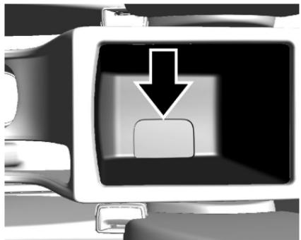
1. Coloque la llave no remota o el transmisor dentro del apoyabrazos, como se muestra en la figura.
