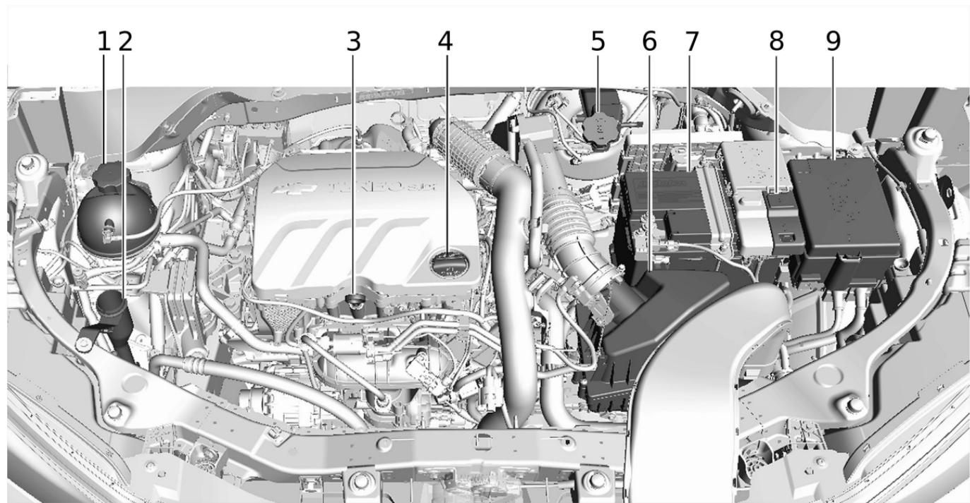
1. Depósito del refrigerante del motor.
