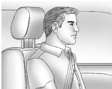
Ajuste el apoyacabezas de modo tal que su parte superior esté a la misma altura que la parte superior de la cabeza del ocupante. Esta posición reduce la probabilidad de una lesión de cuello en un choque.
