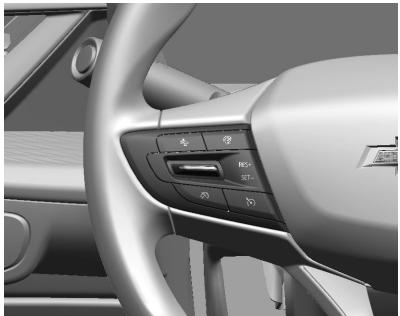
El sistema de control de velocidad crucero y limitador de velocidad se puede manejar con los mandos en el volante.
