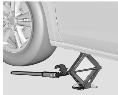
Acople la llave para ruedas y, con la manivela del gato alineada correctamente, gire la llave para ruedas hasta que el neumático se despegue del suelo.
