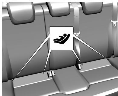
2. Localice la posición de los dos anclajes inferiores. La ubicación de cada ancla inferior se identifica con una marca circular en la parte trasera del cojín.
