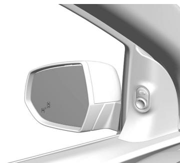
Cuando la velocidad del vehículo supera los 11 km/h, se activa el sistema de alerta del punto ciego lateral. Cuando la velocidad del vehículo es superior a los 140 km/h, se desactiva el sistema y se atenúan las luces indicadoras de los espejos derecho e izquierdo. En este punto, si se reduce la velocidad del vehículo, se apagan las luces indicadoras en los espejos.
