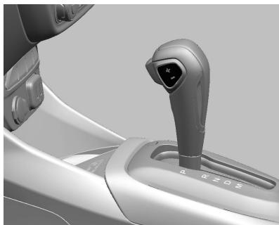
Mueva la palanca selectora a la posición **M**. Presione el botón del cambio ubicado en la palanca selectora.
