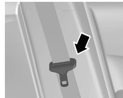
Cuando el cinturón de seguridad no esté en uso, coloque la lengüeta como se muestra en la figura para evitar ruidos causados por el contacto de la misma con el acabado de plástico de la columna.
