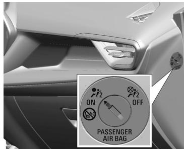
El sistema del airbag del acompañante se puede desactivar mediante una cerradura del costado del tablero de instrumentos, visible cuando se abre la puerta del acompañante.
