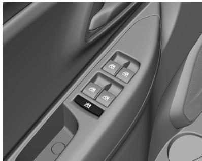
Pulse el interruptor para desactivar los levantavidrios eléctricos traseros. Para activarlos, pulse de nuevo .
