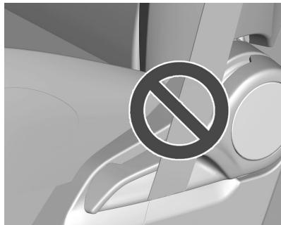
Posición incorrecta del cinturón de seguridad.
