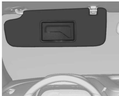
Los parasoles tienen espejos integrados (si está equipado) que se pueden abatir o bascular hacia un lado para evitar el encandilamiento.
