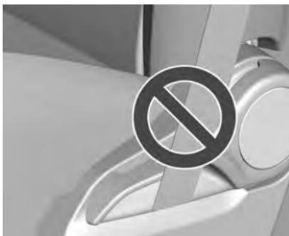
Posición incorrecta del cinturón de seguridad.
