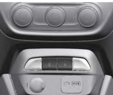
El LED de estado está integrado al botón de bloqueo central cerca del centro del tablero de instrumentos.
