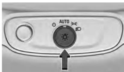
Cuando se activa la función de luces automáticas **AUTO**, el sistema enciende los faros y las luces traseras automáticamente dependiendo de las condiciones exteriores de iluminación.
