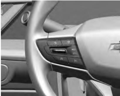
El sistema de control de velocidad crucero y limitador de velocidad se puede manejar con los mandos en el volante.
