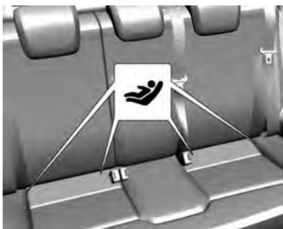
2. Localice la posición de los dos anclajes inferiores. La ubicación de cada anclaje inferior se identifica con una marca circular en la parte trasera del cojín.
