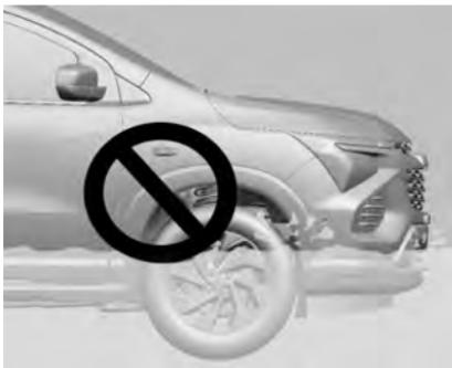
Atraviese la zona inundada a baja velocidad y asegúrese de que el nivel del agua no supere la altura del centro de la rueda.
