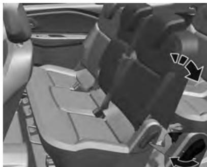
Tire de la palanca hacia adelante, ajuste la inclinación a la posición deseada y suéltela. Deje que el asiento bloquee audiblemente.
