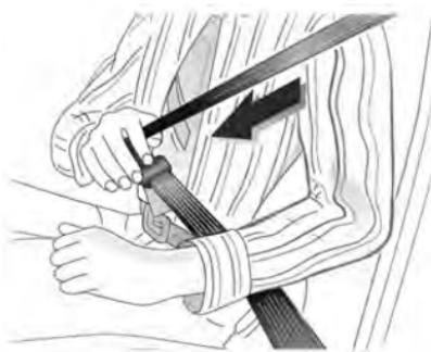
Retire el cinturón, guíelo por el cuerpo sin retorcerlo y coloque la placa de cierre en la hebilla hasta que haga un clic. Durante el viaje, tense frecuentemente el cinturón abdominal tirando suavemente de la banda torácica.
