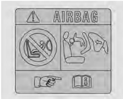
Los vehículos equipados con airbags se pueden identificar porque tienen una etiqueta autoadhesiva con la inscripción "Airbag" en el parasol del lado del acompañante.
