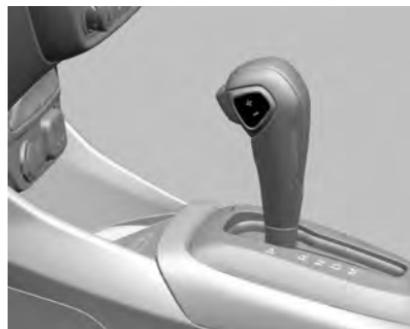
Mueva la palanca selectora a la posición **M**.
