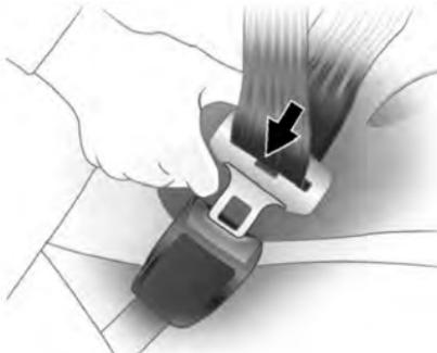
La ropa suelta o muy gruesa impide que el cinturón se ajuste al cuerpo. No coloque ningún objeto, como un bolso o un teléfono móvil, entre el cinturón y el cuerpo.
