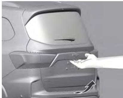
Después del desbloqueo, pulse el panel táctil de abajo de la manija y abra el portón trasero.
