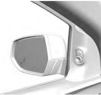
Cuando la velocidad del vehículo supera los 11 km/h, se activa el sistema de alerta del punto ciego lateral. Cuando la velocidad del vehículo es superior a los 140 km/h, se desactiva el sistema y se atenúan las luces indicadoras de los espejos derecho e izquierdo. En este punto, si se reduce la velocidad del vehículo, se apagan las luces indicadoras en los espejos. Si se detecta un vehículo en el punto ciego en este momento, se enciende la luz indicadora del espejo correspondiente.
