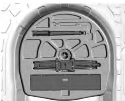
El gato y las herramientas se guardan en un alojamiento del compartimiento de carga, debajo de la cubierta del piso.
