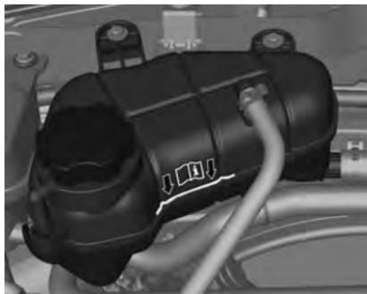
Con el sistema de refrigeración frío, el nivel del refrigerante debe estar por encima de la marca de la línea de llenado. Rellene si el nivel es más bajo. Por lo tanto, agregue en el depósito de compensación una mezcla de agua desmineralizada y aditivo para radiadores (de larga duración - proporción de aditivo del 35% al 50%).
