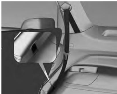
Guíe los cinturones de seguridad a través de sus soportes para asegurarse de que los asientos de la tercera fila no se atasquen al momento de montarlos.
