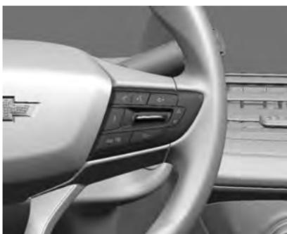
El sistema del cuadro se puede manejar con los controles del volante.
