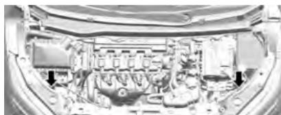
3. Ajuste la nivelación directamente en ambos faros, de acuerdo con el estado de carga especificado previamente.
