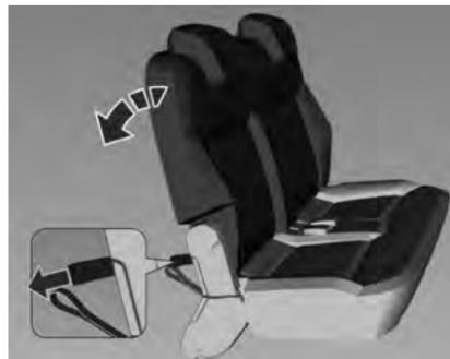
Tire de la correa, ajuste la inclinación y suelte la correa. Deje que el asiento bloquee audiblemente.
