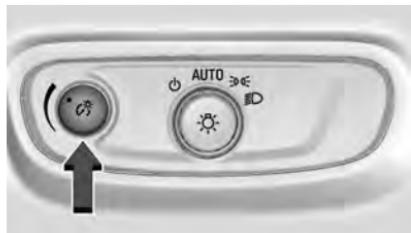
Esta función ajusta el brillo de todos los controles iluminados. El control de iluminación del tablero de instrumentos está junto al control de las luces exteriores.
