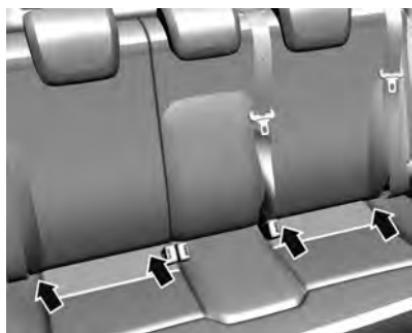
Para instalar un sistema de retención infantil con elementos de amarre inferiores ISOFIX, siga las instrucciones entregadas con el sistema de retención.
