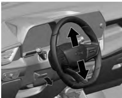
Desbloquee la palanca, ajuste el volante, luego acople la palanca y asegúrese de que esté totalmente bloqueada.
