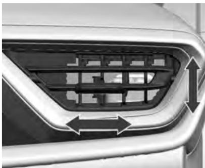
Para abrir las salidas de ventilación laterales, gire las rejillas hacia arriba y gire la rueda de ajuste a la izquierda y la derecha hasta encontrar la dirección deseada.
