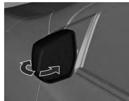
Para la seguridad de los peatones, los retrovisores externos basculan de su posición de montaje normal al recibir impactos de una determinada fuerza. Vuelva a colocar el retrovisor en su posición presionando ligeramente sobre la carcasa. Esta función también es útil para reducir el ancho total del vehículo y evitar daños cuando el vehículo está estacionado. Vuelva a colocar el retrovisor en su posición de funcionamiento antes de conducir.
