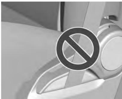
Posición incorrecta del cinturón de seguridad.
