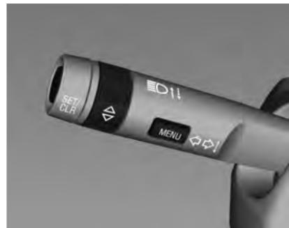
Cada vez que usted gira la perilla de la palanca de las luces de giro en sentido horario, el modo cambia de la siguiente manera:
