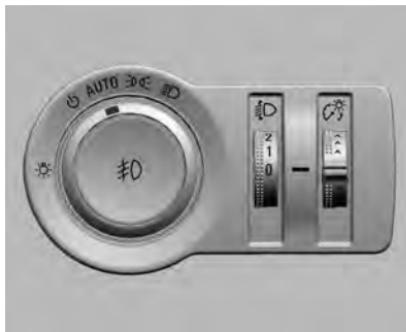
Cuando se activa la función de luces automáticas **AUTO**, el sistema enciende los faros y las luces traseras automáticamente dependiendo de las condiciones exteriores de iluminación.
