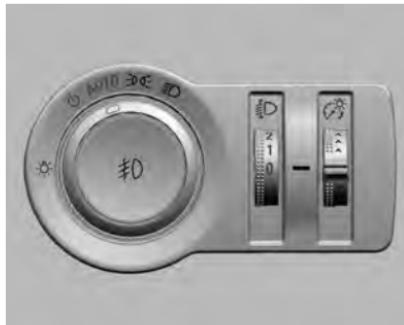
El control de las luces exteriores está a la izquierda de la columna de dirección, en el tablero de instrumentos.
