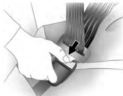
Para liberar el cinturón, pulse el botón del cierre. El cinturón de seguridad vuelve automáticamente a la posición original. Si es necesario, tire del cierre hacia abajo y luego suéltelo para permitir que el cinturón se retraga totalmente.
