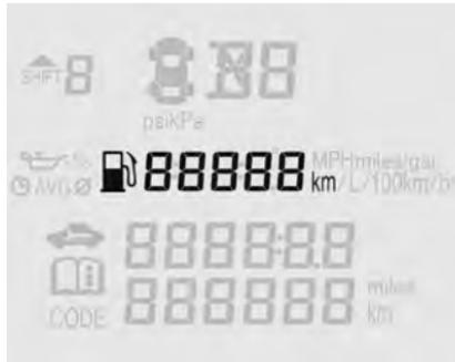
Este modo indica la distancia de conducción estimada para que se agote el combustible disponible actualmente en el depósito de combustible.
