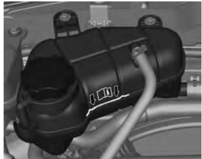
Con el sistema de refrigeración frío, el nivel del refrigerante debe estar por encima de la marca de la línea de llenado. Rellene si el nivel es más bajo. Por lo tanto, agregue en el depósito de compensación una mezcla de agua desmineralizada y aditivo para radiadores (de larga duración - proporción de aditivo del 35% al 50%).
