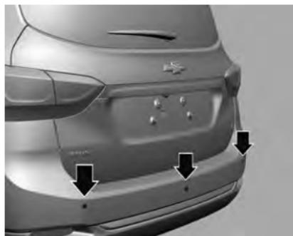
1. Si está equipado, la asistencia de estacionamiento trasera (RPA) utiliza sensores ubicados en el paragolpes trasero para asistir en el estacionamiento y para evitar objetos al retroceder. Funciona a velocidades inferiores a 8 km/h. La RPA puede mostrar un triángulo de advertencia en la pantalla de la cámara de visión trasera (si está equipado) para proporcionar la distancia al objeto. Además, puede producir varios pitidos si está muy cerca de un objeto.
