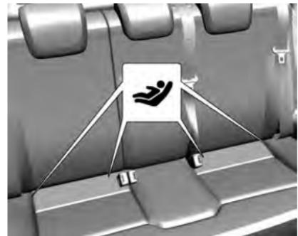
2. Localice la posición de los dos anclajes inferiores. La ubicación de cada anclaje inferior se identifica con una marca circular en la parte trasera del cojín.
