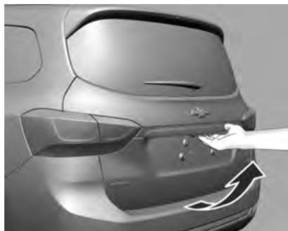
Después del desbloqueo, pulse el panel táctil de abajo de la manija y abra el portón trasero.
