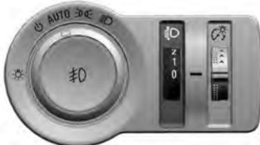
Para adaptar el alcance de los faros a la carga del vehículo y evitar el deslumbramiento: gire la perilla a la posición requerida.
