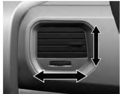
Para abrir las salidas de ventilación laterales, gire las rejillas hacia arriba y gire la rueda de ajuste a la izquierda y la derecha hasta encontrar la dirección deseada.
