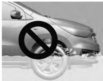
Atraviese la zona inundada a baja velocidad y asegúrese de que el nivel del agua no supere la altura del centro de la rueda.
