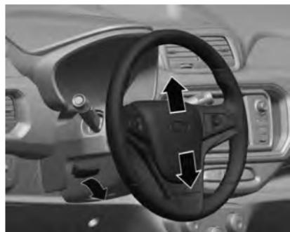
Desbloquee la palanca, ajuste el volante, luego enclave la palanca y asegúrese de que esté totalmente trabada.
