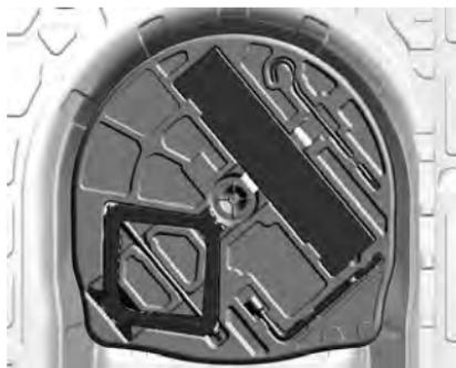
El triángulo de advertencia está guardado debajo del piso del compartimento de carga.
