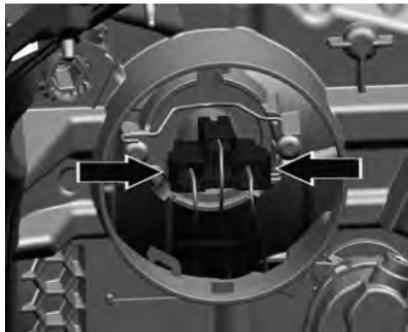
2. Desenchufe el conector de la lámpara.
