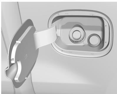
El sistema de recarga sin tapa no cuenta con una tapa para el tubo de recarga. Inserte completamente y trabe la boquilla de recarga, luego comience a recargar.
