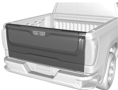
Los interruptores en la compuerta trasera interior evitan que la compuerta primaria se abra cuando la compuerta interior no está completamente cerrada.
