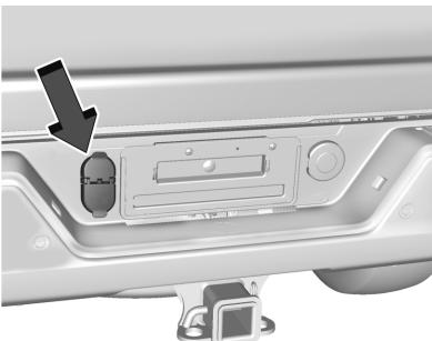
Si está equipado, el arnés de cables del remolque, con un conector de siete pines y un conector de cuatro pines, está instalado en el paragolpes trasero del vehículo.
