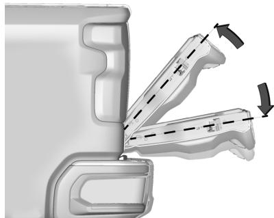
Para cerrar la compuerta trasera con la función de levantar para cerrar, levante la compuerta trasera desde la posición de apertura completa hasta al menos 10 cm (4 pulg.) y sosténgala momentáneamente. Luego, la compuerta trasera comenzará a cerrarse automáticamente. Si la compuerta trasera se levanta más de la mitad del camino entre las posiciones de apertura y cierre, no se cerrará automáticamente.
