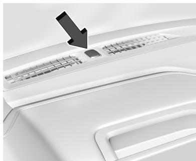
El vehículo tiene un sensor de luz situado en la parte superior del tablero de instrumentos. No cubra el sensor, de lo contrario se encenderán los faros cuando no es necesario.
