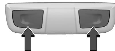
Presione las lentes de las luces para encender o apagar las luces de lectura traseras.
