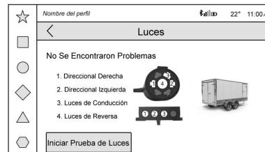
Esta vista muestra los nombres de los pines del conector del remolque, un gráfico del conector del remolque y un gráfico de la parte trasera del remolque.
