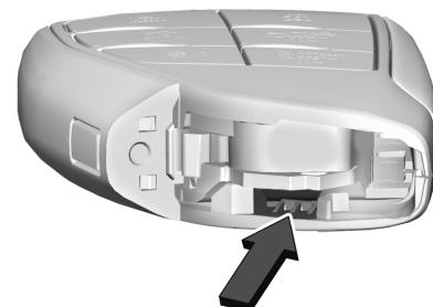
2. Use la hoja de la llave mecánica en la ranura para retirar la cubierta de la batería a mano.
