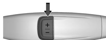
El Modo de selección de rango ayuda a controlar la transmisión y la velocidad del vehículo cuando se conduce cuesta abajo o remolcando un acoplado. Permite la selección manual del rango de marchas deseado.
