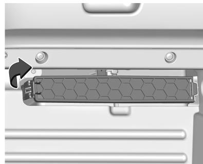
4. Tire de la palanca del lado izquierdo de la puerta del filtro, deslícela hacia la izquierda y retire la puerta. Retire el filtro usado.
