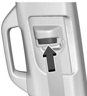
Presione el botón de desbloqueo para mover el ajuste de seguridad a la posición deseada.
