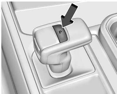
**P:** Esta posición bloquea las ruedas traseras. Use P (Estacionado) al arrancar el motor para evitar que el vehículo se mueva fácilmente.
