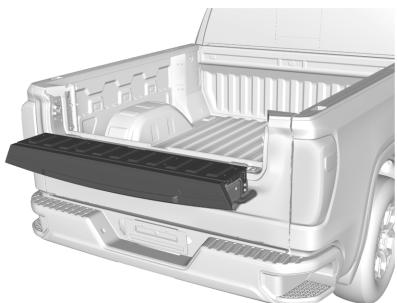
Para abrir la compuerta trasera interior, presione el panel táctil superior que está en la manija de la compuerta luego de desbloquear todas las puertas. Tire de la parte superior de la compuerta trasera para abrirla.
