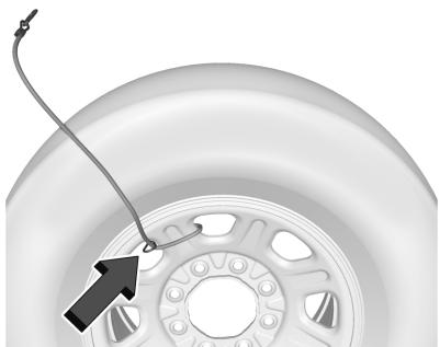
11. Cable del neumático de auxilio (si está equipado)
