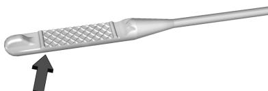
Si el aceite está por debajo del área con rayas cruzadas en la punta de la varilla de medición y el motor ha estado apagado como mínimo 15 minutos, agregue 1 L (1 qt) del aceite recomendado y luego vuelva a comprobar el nivel. Consulte "Selección del aceite correcto para el motor" más adelante en esta sección para ver la explicación acerca de la clase de aceite a usar. Para conocer la capacidad del cárter de aceite del motor, consulte *Capacidades y especificaciones* ▷ 454.
