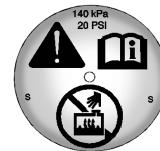
1. Retire la tapa a presión del tanque de expansión de refrigerante cuando el sistema de refrigeración, incluida la tapa a presión del tanque de expansión de refrigerante y la manguera superior del radiador ya no estén calientes. Gire la tapa de presión lentamente, hacia la izquierda, una vuelta completa. Si se escucha un silbido, espere que cese. Un soplo significa que todavía queda presión en su interior.
