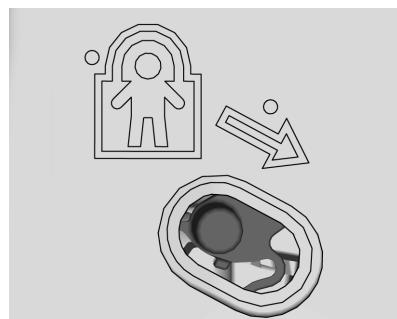
Las trabas de seguridad se encuentran en los bordes interiores de las puertas traseras. Para activar la cerradura de seguridad:
