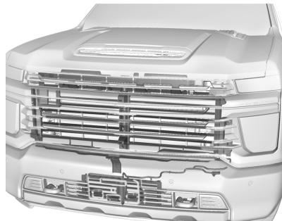
El vehículo puede contar con un sistema de obturador diseñado para ayudar a mejorar el rendimiento del combustible. Mantenga el sistema del obturador libre de residuos, nieve y hielo. Si el testigo de revisión del motor se activa, compruebe que el sistema del obturador esté libre de residuos, nieve y hielo.
