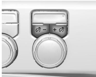
Esta función ajusta el brillo de todos los controles iluminados. El control de iluminación del tablero de instrumentos está junto al control de las luces exteriores.
