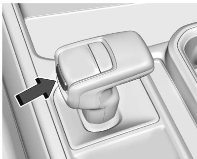
Este vehículo está equipado con transmisión controlada electrónicamente. El botón de liberación del bloqueo de la palanca de cambios está diseñado para evitar sacar la transmisión de P (Estacionamiento) accidentalmente, a menos que el vehículo esté en marcha, el pedal del freno esté presionado y el botón de liberación del bloqueo de la palanca de cambios esté pulsado.
