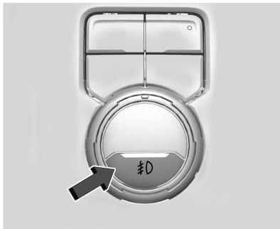
Si está equipado, el control de faros antiniebla está cerca del control de luces exteriores, a la izquierda de la columna de dirección.
