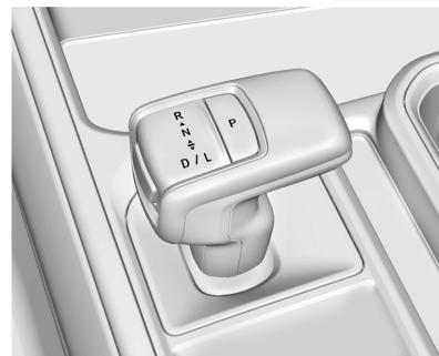
El patrón de cambios se muestra en la parte superior de la palanca de cambios. La posición de marcha seleccionada se enciende en rojo en la palanca de cambios, mientras que todas las demás se muestran en blanco. Si el cambio no es inmediato, como en condiciones muy frías, el indicador en el interruptor de cambio puede parpadear hasta que esté completamente enganchado.
