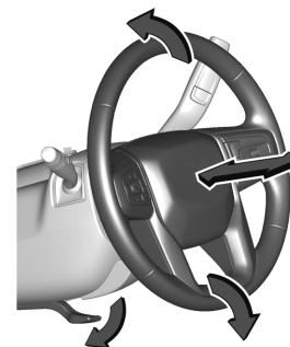
Para ajustar el volante inclinable y telescopico si está equipado:
