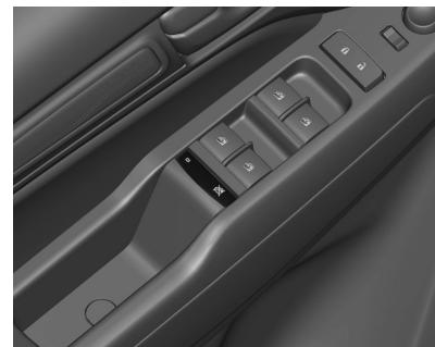
Pulse el interruptor
