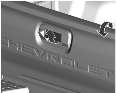
Para abrirlo, tire de la manija central y baje el portón. Para cerrarlo, levante el portón y presione los extremos superiores hasta que sienta un ruido de bloqueo.
