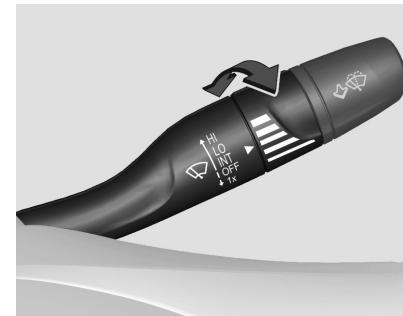
Palanca del limpiaparabrisas en la posición **INT**.
