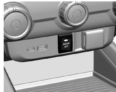
Si está equipado, el sistema de aire acondicionado trasero se acciona con el botón **REAR A/C** (A/A trasero).
