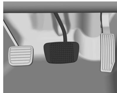
Cuando se pisa el pedal del freno, se encienden las luces de freno traseras y la tercera luz de freno.
