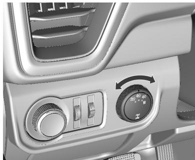
Gire el interruptor de control del cambio para acoplar y desacoplar la tracción en las cuatro ruedas. Puede elegir entre lo siguiente:
