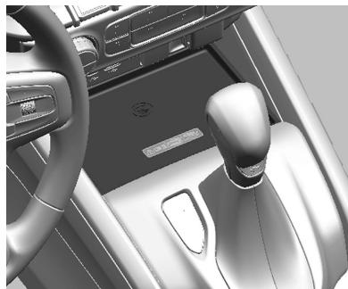
El encendido debe estar en contacto en la posición On/Run (Encendido/Marcha), ACC/ACCESORY (ACCESORIO), o debe estar activa la alimentación de accesorios retenida (RAP). La función de carga inalámbrica puede no
