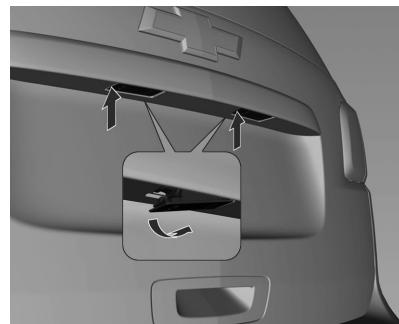
1. Inserte el destornillador del lado izquierdo del alojamiento de la lámpara, presione hacia el costado y suelte el resorte.
