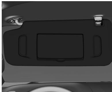
Los parasoles tienen espejos de cortesía. Cuando se abren las cubiertas de los espejos de cortesía, se enciende la luz del parasol.
