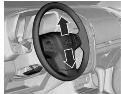
Desbloquee la palanca, ajuste el volante, luego acople la palanca y asegúrese de que esté totalmente bloqueada.
