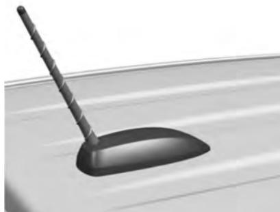
Para desmontar la antena del techo, gírela hacia la izquierda. Para instalar la antena del techo, gírela hacia la derecha.
