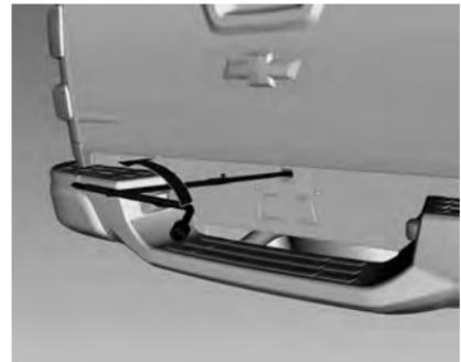
3. Gire la llave de ruedas en sentido antihorario para bajar el neumático de auxilio hasta el suelo. Continúe girando la llave de ruedas hasta que el neumático de auxilio se pueda extraer desde abajo del vehículo.
