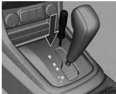
3. Inserte un destornillador en el orificio hasta que se desbloquee la palanca, saque la palanca selectora de la posición P y muévala a la posición N.
