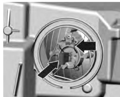
2. Desenchufe el conector de la lámpara.
