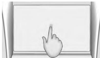
La función de desplazar se usa para mover elementos una distancia corta en una lista sobre un mapa (si está disponible). Para desplazar, mantenga y mueva el elemento seleccionado hacia arriba o abajo a una ubicación nueva.
