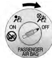
Si el tablero de instrumentos tiene el interruptor que se muestra en la ilustración, el vehículo cuenta con un interruptor de activación/desactivación de los airbags que se puede usar para activar o desactivar manualmente el airbag del acompañante.
