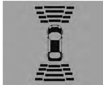
El tablero de instrumentos puede tener una visualización de la asistencia para estacionamiento con barras que muestran la "distancia al objeto" e información sobre la ubicación del objeto para el sistema de asistencia para estacionamiento. A medida que el objeto se acerca, se iluminan más barras.
