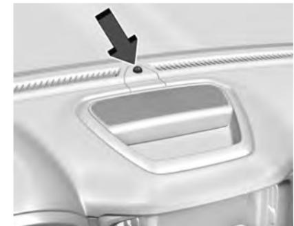
El vehículo cuenta con un sensor de luz en la parte superior del tablero de instrumentos, el cual controla el sistema automático de faros. No cubra el sensor, de lo contrario se podrían encender los faros cuando no sean necesarios.
