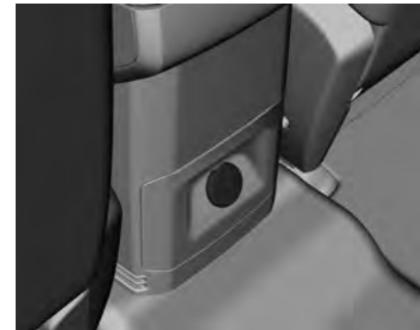
La toma de tensión de 12V está en la parte trasera de la consola central delantera.
