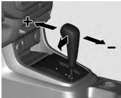
Mueva la palanca de cambios desde la posición D (Conducción) hacia la izquierda y luego hacia delante o hacia atrás.
