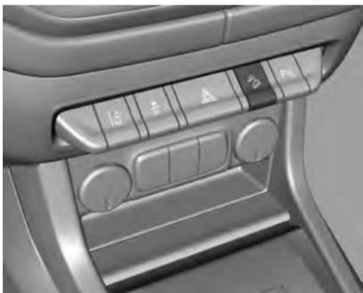
A velocidades inferiores a 30 km/h (19 mph), pulse el botón . Se enciende el indicador de control verde del tablero de instrumentos. El indicador de control verde destellará en el tablero de instrumentos cuando el HDC esté en funcionamiento.
