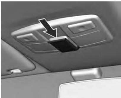
Hay un sujetador de ticket de estacionamiento en el medio de las luces de lectura y los interruptores. Para usarlo, tirelo hacia abajo con cuidado y coloque el ticket.
