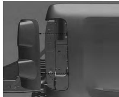
2. Retire el conjunto de la luz trasera tirando en forma recta para extraerlo de la carrocería. Asegúrese de que el conducto de cables permanezca en su posición.
