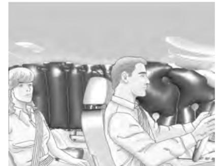
Si el vehículo cuenta con airbags en las barras del techo para el conductor, el acompañante delantero lateral y los pasajeros laterales del asiento trasero, los mismos se encuentran en el techo, sobre las ventanas laterales.
