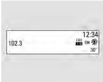
Pulse **RADIO** repetidamente para cambiar entre RADIO AM → RADIO FM.
