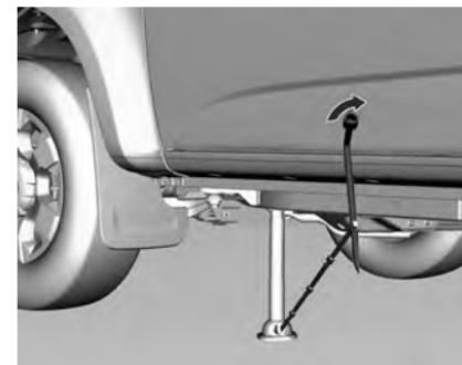
Si el neumático desinflado está en la parte delantera del vehículo, coloque el gato detrás del neumático delantero en el bolsillo del borde del bastidor.
