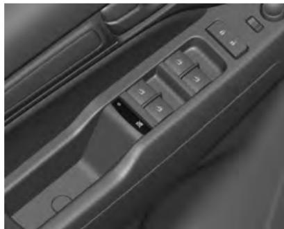
Pulse el interruptor
