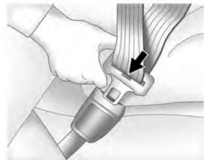
3. Empuje la lengüeta metálica dentro de la hebilla hasta oír un clic. Tire de la lengüeta metálica para asegurarse de que esté bien insertada. Coloque el botón de desbloqueo de la hebilla de manera de poder abrir el cinturón de seguridad rápidamente en caso de necesidad.
