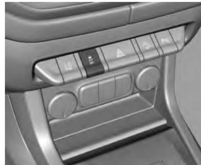
Para conducción de muy alto desempeño, se puede desactivar el ESC manteniendo pulsado el botón
