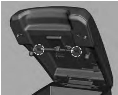
Use esta guía, que se muestra en la figura anterior, para evitar pinzar el cable auxiliar al bajar el apoyabrazos cuando esté usando el cable.
