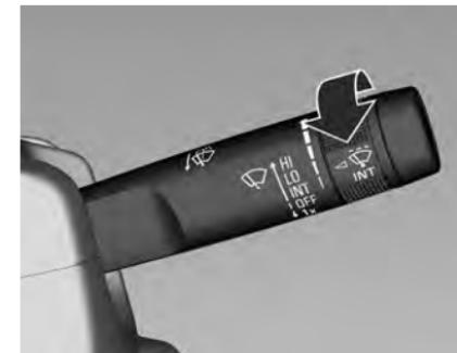
Palanca del limpiaparabrisas en posición .
