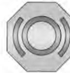
El tapón del depósito de líquido de frenos/embrague hidráulico tiene este símbolo. El depósito del líquido de frenos/embrague común se llena con líquido de frenos DOT 4LV, tal como se indica en el tapón del depósito. Vea la ubicación del depósito en *Vista del compartimento del motor* ▷ 219.
