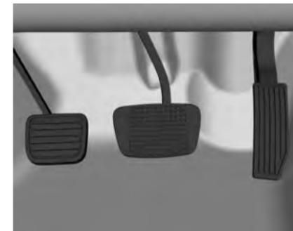
Para asegurar que no haya interferencia con la carrera del pedal del freno, compruebe la instalación correcta de los cubrealfombras.
