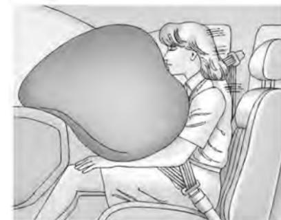
El airbag frontal del pasajero delantero exterior está en el lado del pasajero del tablero de instrumentos.
