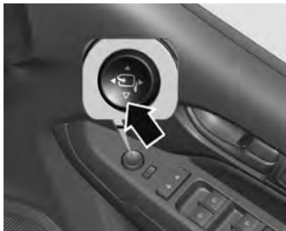
Pulse el interruptor selector (interruptor L/R) en la posición central, y luego pulse el interruptor de cuatro direcciones para plegar electrónicamente los espejos. Púlselo nuevamente para desplegarlos.
