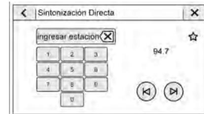
Acceda a Sintonización directa tocando en la pantalla del infoentretenimiento para mostrar el teclado. Navegue por todas las frecuencias usando las flechas que se
