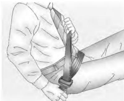
5. Para tensar la parte de la cintura, tire hacia arriba de la banda toráxica.
