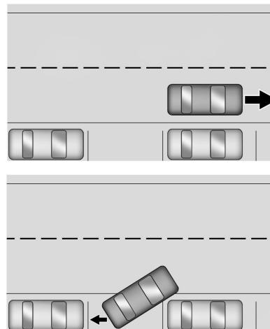
Después de pasar completamente esta ranura, el APA le indica al conductor detener el vehículo y cambiar a R (marcha atrás) para activar la conducción automática. El volante vibra brevemente para recordarle que quite las manos del mismo. Mire a los alrededores y continúe frenando o acelerando según sea necesario, y esté listo para frenar para evitar vehículos, peatones y objetos.
