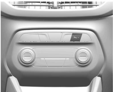
Si está equipado, el botón **P** se usa para activar o desactivar el asistente de estacionamiento delantero o trasero al mismo tiempo. La luz indicadora junto al botón se enciende cuando las funciones están activadas, y se apaga cuando se han deshabilitado las funciones.
