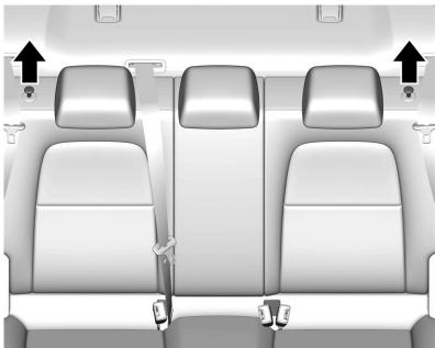
4. Tire de la palanca de la parte superior del respaldo para desbloquearlo.
