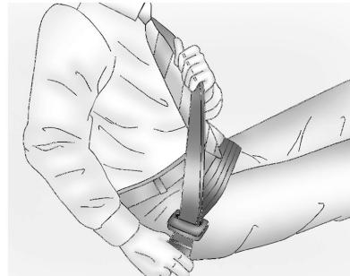
4. Para tensar la parte de la cintura, tire hacia arriba de la banda toráxica.
