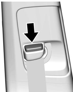
Presione el botón de desbloqueo y mueva el ajuste de seguridad a la posición deseada. El ajuste se puede mover empujando el deslizador. Una vez que el ajuste esté en la posición deseada, trate de moverlo hacia abajo sin presionar el botón de desbloqueo para verificar que se ha trabado en la posición deseada.
