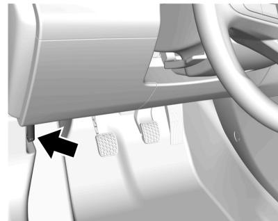
Tire de la palanca de liberación del capó. Está dentro del vehículo, a la izquierda de la columna de dirección.
