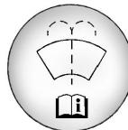
Abra el tapón con que tiene el símbolo del lavaparabrisas. Agregue líquido del lavaparabrisas hasta que se llene el tanque. Vea la ubicación del depósito en *Vista del*
