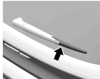
En los vehículos hatchback, levante el brazo del limpialuneta. Empuje la escobilla hacia abajo, con un leve ángulo en relación al brazo, hasta que se desenclave.
