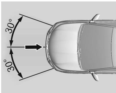
El sistema de airbags frontales se activa en caso de choque de una determinada gravedad en el sector indicado. El encendido debe estar conectado.
