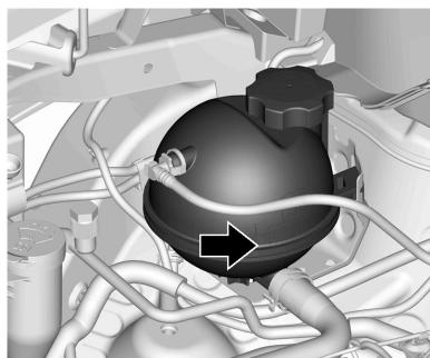
El tanque de compensación del refrigerante está ubicado en el compartimiento del motor, del lado del acompañante. Consulte *Vista del compartimento del motor (Motor turbo L3 1.0L)* ▷ 185 *Vista del compartimento del motor (Motor 1.0L L3)* ▷ 187.
