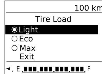
Para establecer la carga de los neumáticos en el menú del Centro de información para el conductor (DIC), detenga el vehículo y aplique el freno de estacionamiento. En los vehículos con transmisión automática, coloque la palanca de cambios en P (Estacionamiento).
