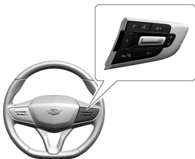
Use el control derecho del volante para abrir y desplazarse por los distintos ítems y visualizaciones.
