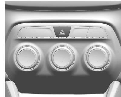
▲ : Pulse ▲ para hacer destellar las luces de giro delanteras, traseras y laterales. Presiónelo nuevamente para apagar las balizas.
