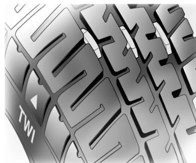
La profundidad mínima autorizada legalmente (1,6 mm) se ha alcanzado cuando el dibujo se desgastó hasta uno de los indicadores de desgaste (TWI). Su posición se indica mediante marcas en el costado del neumático.
