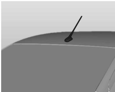
Para desmontar la antena del techo, gírela hacia la izquierda. Para instalar la antena del techo, gírela hacia la derecha.
