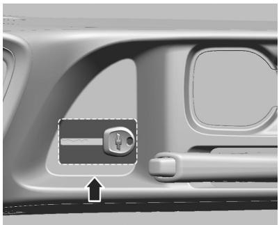
Coloque la llave no remota o el control remoto en la consola central o en el apoyabrazos. En las figuras se muestran las posiciones correctas.
