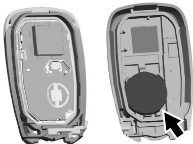
3. Saque la batería empujándola, y deslizándola hacia la parte de abajo del transmisor.
