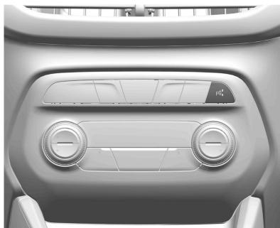
Pulse **P** para habilitar el sistema para buscar un espacio de estacionamiento que sea lo suficientemente largo y esté dentro de 1,5 m (5 ft) del vehículo. La velocidad del vehículo debe ser inferior a los 30 km/h (18 mph).
