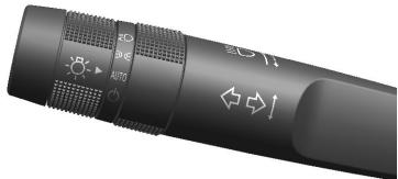
Para señalizar un giro, mueva la palanca hacia arriba o hacia abajo, hasta el tope.
