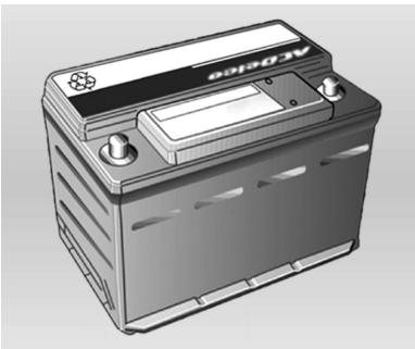
La batería ACDelco instalada en su vehículo no requiere mantenimiento periódico. Si el vehículo no se va a usar durante 30 días o más, desconecte el cable negativo de la batería para evitar que se descargue.
