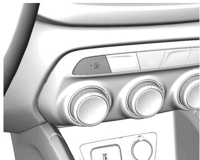
**🔒** : Pulse para bloquear las puertas. La luz testigo se enciende cuando la puerta está bloqueada. Para desbloquear la puerta, vuelva a pulsar el interruptor.
