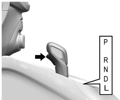
**P:** Esta posición bloquea las ruedas de tracción. Use P (Estacionamiento) al arrancar el vehículo ya que el vehículo no se puede mover fácilmente.
