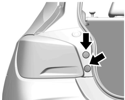
1. Extraiga y guarde los dos tornillos que fijan el conjunto de luz trasera a la carrocería del vehículo.
