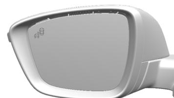
Cuando la velocidad del vehículo supera los 10 km/h, se activa el sistema de alerta del punto ciego lateral. Cuando la velocidad del vehículo es superior a los 140 km/h, se desactiva el sistema y se atenúan las luces indicadoras de los espejos derecho e izquierdo. En este punto, si se reduce la velocidad del vehículo, se apagan las luces indicadoras en los espejos. Si se detecta un vehículo en el punto ciego en este momento, se enciende la luz indicadora del espejo correspondiente.
