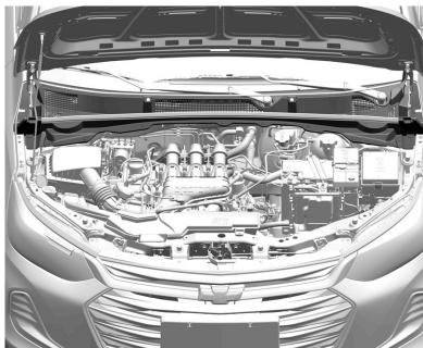
La entrada de aire en el compartimiento del motor, delante del parabrisas, debe estar libre para permitir la entrada de aire. Retire cualquier resto de hojas, suciedad o nieve.
