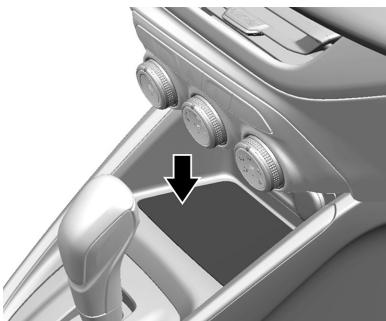
El encendido debe estar en contacto en la posición ACC/ACCESORY (ACCESORIO), o debe estar activa la alimentación retenida para accesorios (RAP). La función de carga inalámbrica puede no indicar correctamente que está cargando cuando el vehículo está en RAP. Consulte *Alimentación de accesorios retenida (RAP)* ▷ 155.
