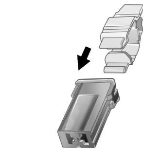
Coloque el extractor de fusibles sobre los diversos tipos de fusible, desde la parte superior o lateral, y extraiga el fusible.
