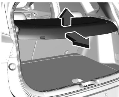
Para quitar la cubierta del vehículo, desate la cuerda y retire la cubierta de la ranura. Para volver a instalarla, coloque cada extremo de la cubierta en las ranuras y deslícela hasta el final de las ranuras a ambos lados. Asegúrese de que ambos lados estén correctamente instalados conforme a la imagen a continuación. Ate la cuerda a la compuerta levadiza.
