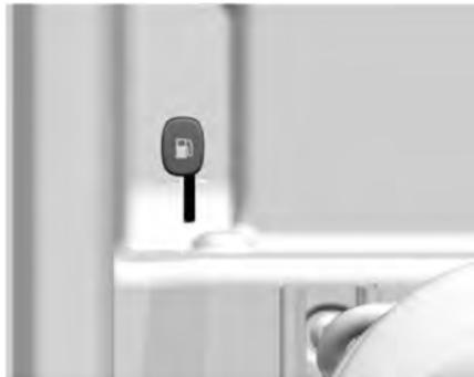
Levante la manija de la puerta del tanque de combustible del lado del asiento del conductor para abrir la puerta del tanque de combustible.
