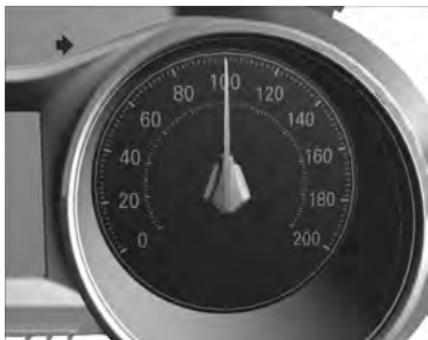
El velocímetro indica la velocidad del vehículo en kilómetros por hora (km/h).
