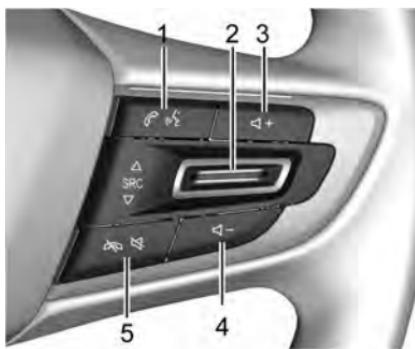
**1 = ☎ / ☎ :** En vehículos con Bluetooth u OnStar, pulse para interactuar con estos sistemas y para aceptar una llamada entrante.
