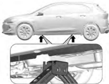
3. Ajuste el gato a la altura necesaria. Coloque el gato directamente debajo del punto de elevación, de modo que no pueda resbalar.
