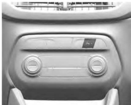
Si está equipado, el botón P//A se usa para activar o desactivar el asistente de estacionamiento delantero o trasero al mismo tiempo. La luz indicadora junto al botón se enciende cuando las funciones están activadas, y se apaga cuando se han deshabilitado las funciones.
