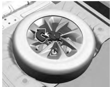
5. Coloque la rueda de tamaño normal dañada en la cavidad para la rueda de auxilio y ajuste la tuerca mariposa.
