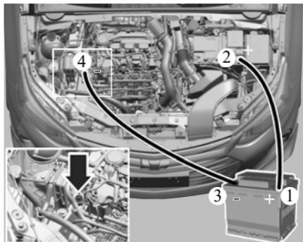
9. Conecte los cables de arranque en la secuencia que se indica:
