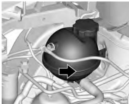
El tanque de compensación del refrigerante está ubicado en el compartimiento del motor, del lado del acompañante. Consulte *Vista del compartimento del motor (Motor turbo L3 1.0L)* ▷ 171 *Vista del compartimento del motor (Motor 1.0L L3)* ▷ 173.
