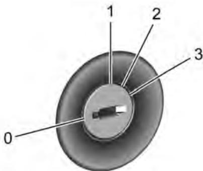
El interruptor de encendido tiene cuatro posiciones para la llave:
