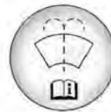
Abra el tapón con que tiene el símbolo del lavaparabrisas. Agregue líquido del lavaparabrisas hasta que se llene el tanque. Vea la ubicación del depósito en *Vista del compartimento del motor (Motor turbo L3 1.0L)* ▷ 171 *Vista del compartimento del motor (Motor 1.0L L3)* ▷ 173.
