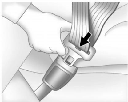
3. Empuje la lengüeta metálica dentro de la hebilla hasta oír un clic. Tire de la lengüeta metálica para asegurarse de que esté bien insertada. Coloque el botón de desbloqueo de la hebilla de manera de poder abrir el cinturón de seguridad rápidamente en caso de necesidad.
