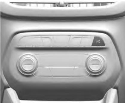
Pulse para habilitar el sistema para buscar un espacio de estacionamiento que sea lo suficientemente largo y esté dentro de 1,5 m (5 ft) del vehículo. La velocidad del vehículo debe ser inferior a los 30 km/h (18 mph).
