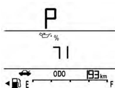
Indica una estimación de la vida útil del aceite. El número en porcentaje representa el resto de vida del aceite actual. Para restablecerla a cero, consulte "Cómo restablecer a cero el sistema de la vida útil del aceite del motor" en *Sistema de vida útil del aceite del motor* ▷ 174.
