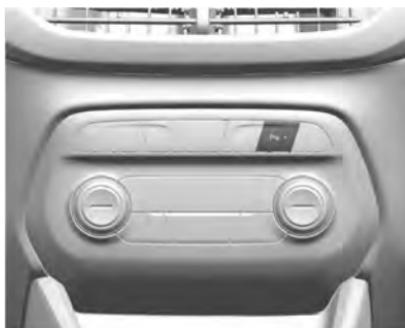
Si está equipado, el botón P/V/A se usa para activar o desactivar el asistente de estacionamiento delantero o trasero al mismo tiempo. La luz indicadora junto al botón se enciende cuando las funciones están activadas, y se apaga cuando se han deshabilitado las funciones.
