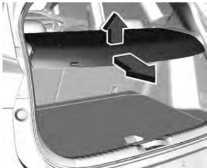
Para quitar la cubierta del vehículo, desate la cuerda y retire la cubierta de la ranura. Para volver a instalarla, coloque cada extremo de la cubierta en las ranuras y deslícela hasta el final de las ranuras a ambos lados.
