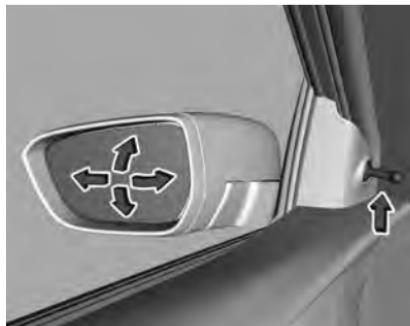
Ajustar manualmente los retrovisores exteriores con la palanca.
