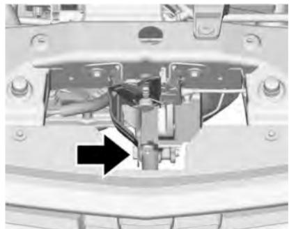
Empuje el cierre de seguridad hacia el lado del conductor y abra el capó.
