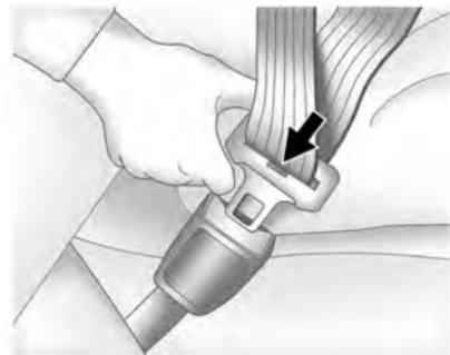
3. Empuje la lengüeta metálica dentro de la hebilla hasta oír un clic.
