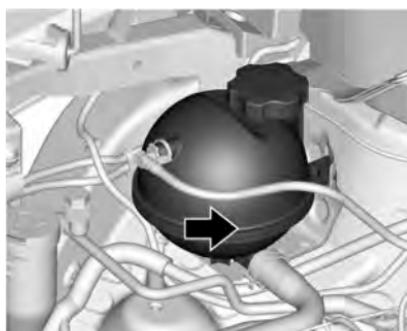
El tanque de compensación del refrigerante está ubicado en el compartimiento del motor, del lado del acompañante. Consulte *Vista del compartimento del motor (Motor turbo L3 1.0L)* ▷ 169 o *Vista del compartimento del motor (Motor 1.0L L3)* ▷ 171.
