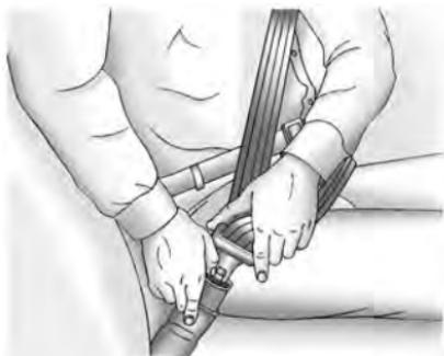
Para abrir el cinturón, presione el botón de la hebilla. El cinturón debe volver a la posición de guardado.
