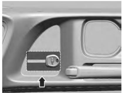
Coloque la llave no remota o el control remoto en la consola central o en el apoyabrazos. En las figuras se muestran las posiciones correctas.
