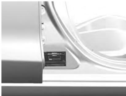
La placa de identificación del vehículo está situada en el pilar de la puerta delantera derecha.
