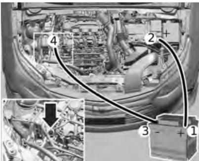
9. Conecte los cables de arranque en la secuencia que se indica:
