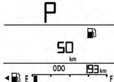
La autonomía se calcula según el nivel actual de combustible y el consumo actual. La pantalla muestra valores promedio. Luego de cargar combustible, la autonomía se actualiza automáticamente luego de unos segundos.
