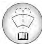
Abra el tapón con que tiene el símbolo del lavaparabrisas. Agregue líquido del lavaparabrisas hasta que se llene el tanque. Vea la ubicación del depósito en *Vista del compartimento del motor (Motor turbo L3 1.0L)* ▷ 169 o *Vista del compartimento del motor (Motor 1.0L L3)* ▷ 171.
