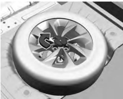
5. Coloque la rueda de tamaño normal dañada en la cavidad para la rueda de auxilio y ajuste la tuerca mariposa.
