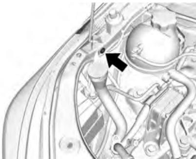
Para reemplazar las lámparas del lado del acompañante, primero debe quitar la boquilla de llenado del depósito del lavaparabrisas.
