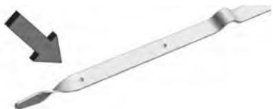
Si el aceite está por debajo del área con rayas cruzadas en la punta de la varilla de medición y el motor ha estado apagado como mínimo 15 minutos, agregue 1 L del aceite recomendado y luego vuelva a comprobar el nivel. Consulte "Selección del aceite correcto para el motor" más adelante en esta sección para ver la explicación acerca de la clase de aceite a usar.
