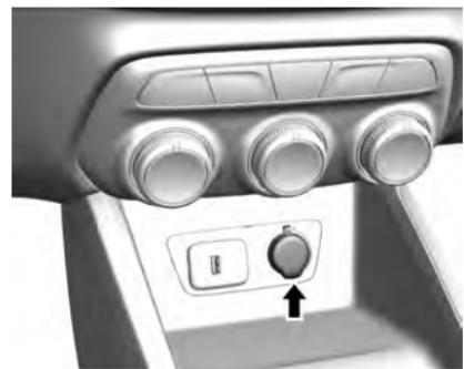
Los tomacorrientes para accesorios se pueden usar para enchufar equipos eléctricos, tales como teléfonos móviles, cargadores de GPS o cualquier otro dispositivo de 12 V que no exceda los 120 W.
