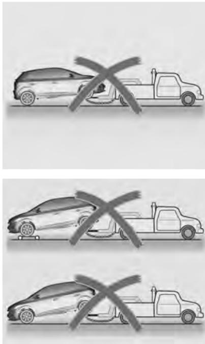
El remolque con dos de las ruedas levantadas del piso no es apropiado para este vehículo.
