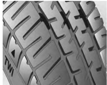
Los neumáticos también deben sustituirse cuando la profundidad del dibujo se haya desgastado hasta el indicador de desgaste (TWI). La imagen muestra como se puede comprobar la profundidad del dibujo.
