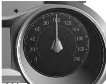
El velocímetro indica la velocidad del vehículo en kilómetros por hora (km/h).
