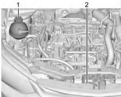
**Se muestra el tanque de compensación del refrigerante para motor turbo; los demás son similares**
