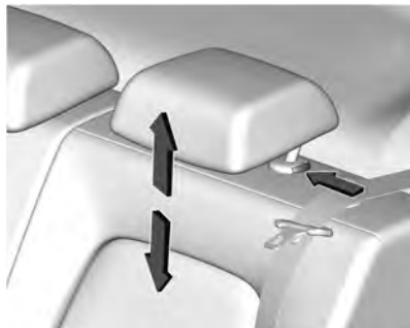
Se puede ajustar la altura del apoyacabezas. Tire del apoyacabezas hacia arriba para levantarla. Intente mover el apoyacabezas para verificar que está trabado en su lugar.
