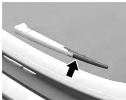
En los vehículos hatchback, levante el brazo del limpialuneta. Empuje la escobilla hacia abajo, con un leve ángulo en relación al brazo, hasta que se desenclave.
