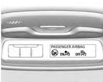
Siempre que el testigo de control **ON** esté encendido, los sistemas de airbag del asiento del acompañante se inflarán en caso de choque.
