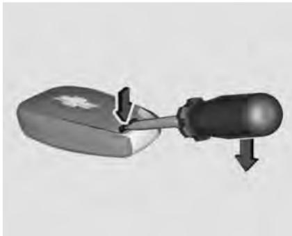
1. Inserte un destornillador plano en la ranura y separe la cubierta trasera de la unidad del control remoto.
