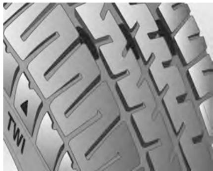
Los neumáticos también deben sustituirse cuando la profundidad del dibujo se haya desgastado hasta el indicador de desgaste (TWI). La imagen muestra como se puede comprobar la profundidad del dibujo.
