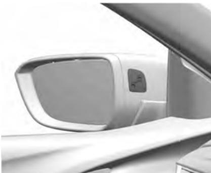
Cuando la velocidad del vehículo supera los 10 km/h, se activa el sistema de alerta del punto ciego lateral. Cuando la velocidad del vehículo es superior a los 140 km/h, se desactiva el sistema y se atenúan las luces indicadoras de los espejos derecho e izquierdo. En este punto, si se reduce la velocidad del vehículo, se apagan las luces indicadoras en los espejos. Si se detecta un vehículo en el punto ciego en este momento, se enciende la luz indicadora del espejo correspondiente.
