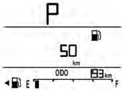
La autonomía se calcula según el nivel actual de combustible y el consumo actual. La pantalla muestra valores promedio. Luego de cargar combustible, la autonomía se actualiza automáticamente luego de unos segundos.
