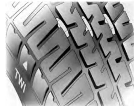
La profundidad mínima autorizada legalmente (1,6 mm) se ha alcanzado cuando el dibujo se desgastó hasta uno de los indicadores de desgaste (TWI). Su posición se indica mediante marcas en el costado del neumático.
