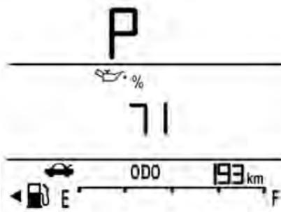
Indica una estimación de la vida útil del aceite. El número en porcentaje representa el resto de vida del aceite actual. Para restablecerla a cero, consulte "Cómo restablecer a cero el sistema de la vida útil del aceite del motor" en *Sistema de vida útil del aceite del motor* ▷ 176.
