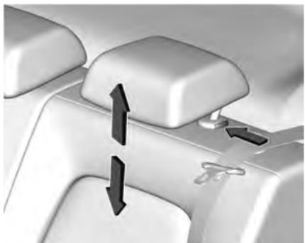
Se puede ajustar la altura del apoyacabezas. Tire del apoyacabezas hacia arriba para levantarla. Intente mover el apoyacabezas para verificar que está trabado en su lugar.
