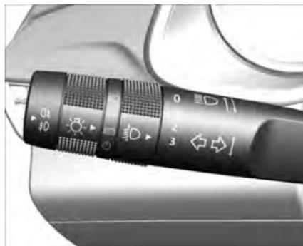
☰●: Con los faros encendidos, para encender la luz alta, empuje la palanca de las luces de giro hacia adelante y suéltela. Para volver a las luces bajas de los faros, empuje la palanca nuevamente o tírela hacia usted y suéltela.
