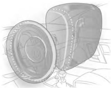
Los airbags frontales son dispositivos de seguridad supplementarios que, junto con los cinturones de los asientos delanteros, incrementan la protección de los ocupantes delanteros en una colisión frontal que implique una fuerte desaceleración del vehículo. Su función es proteger la cabeza y el tórax del impacto violento contra el volante o el tablero de instrumentos en accidentes donde los cinturones de seguridad no basten para evitar lesiones graves o fatales.
