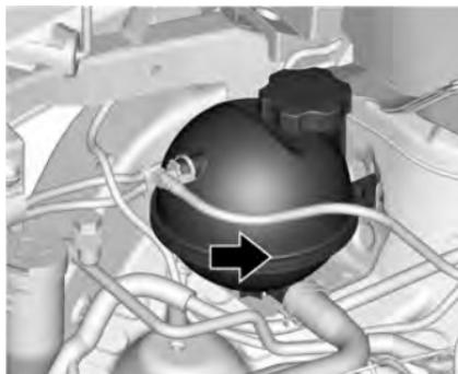
El tanque de compensación del refrigerante está ubicado en el compartimiento del motor, del lado del acompañante. Consulte *Vista del compartimento del motor (Motor turbo L3 1.0L)*  $\Rightarrow$  171 *Vista del compartimento del motor (Motor 1.0L L3)*  $\Rightarrow$  173.
