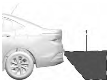
1. Vista mostrada por la cámara
