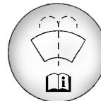
Abra el tapón con que tiene el símbolo del lavaparabrisas. Agregue líquido del lavaparabrisas hasta que se llene el tanque. Vea la ubicación del depósito en *Vista del compartimento del motor (Inyección directa)* ▷ 181.
