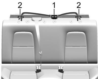
La correa superior seguirá a través de los lazos (2) al anclaje de fijación superior (1). Asegúrese de leer las siguientes instrucciones para instalar correctamente un asiento para niños usando estos lazos y anclaje.
