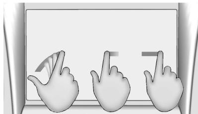
Lanzar o Deslizar se usan para desplazarse por una lista, desplazar horizontalmente el mapa o cambiar las vistas de página. Haga esto poniendo un dedo sobre la pantalla y luego desplázandolo rápidamente hacia arriba y hacia abajo, o hacia la derecha y hacia la izquierda.
