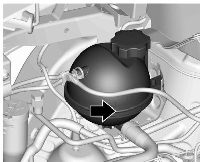
El tanque de compensación del refrigerante está ubicado en el compartimiento del motor, del lado del acompañante. Consulte *Vista del compartimento del motor (Inyección directa)* ↪ 181.
