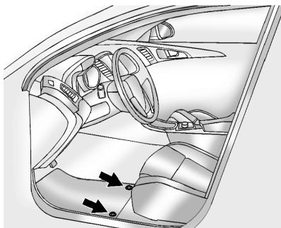
Se muestra la opción con dos retenedores de fijación; con un retenedor de fijación, es similar
