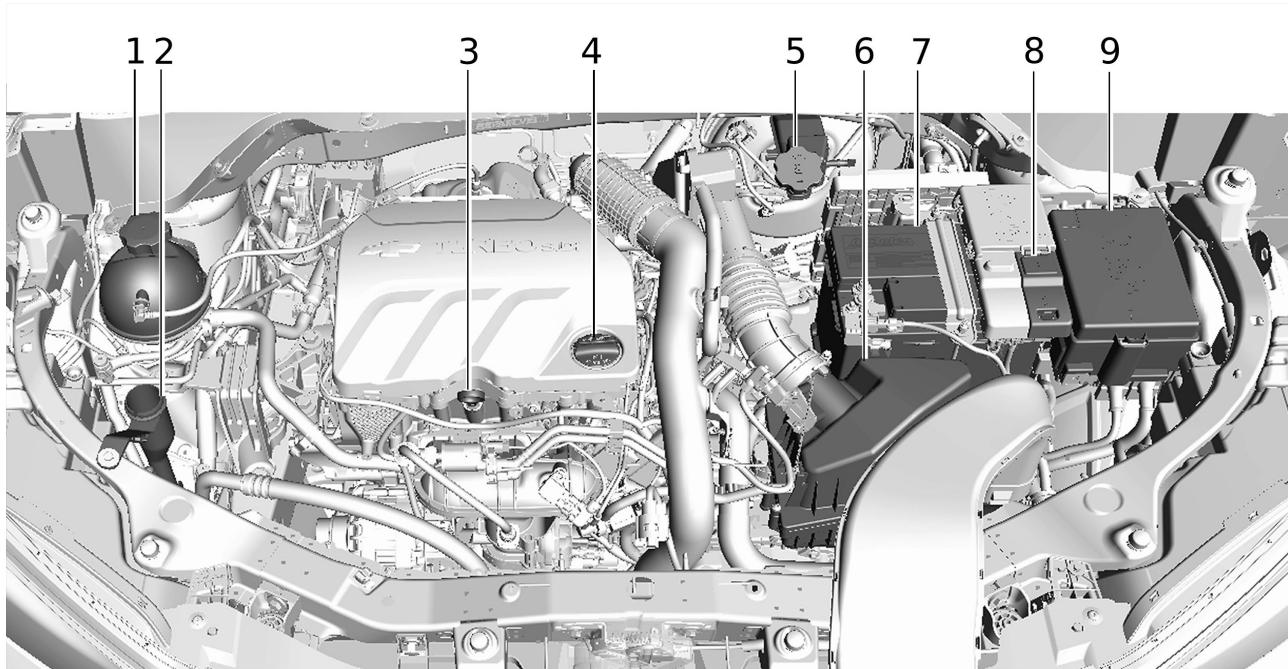
1. Depósito del refrigerante del motor.
