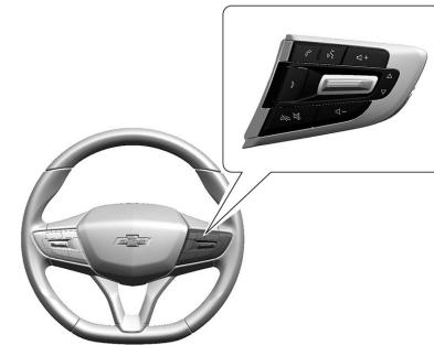
Use el control derecho del volante para abrir y desplazarse por los distintos ítems y visualizaciones.
