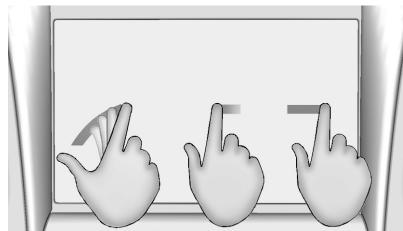
Lanzar o Deslizar se usan para desplazarse por una lista, desplazar horizontalmente el mapa o cambiar las vistas de página. Haga esto poniendo un dedo sobre la pantalla y luego desplazándolo rápidamente hacia arriba y hacia abajo, o hacia la derecha y hacia la izquierda.
