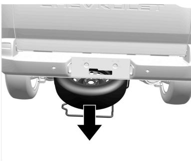
7. Levante levemente la jaula del neumático de auxilio y desenclave los extremos de ambos ganchos.
