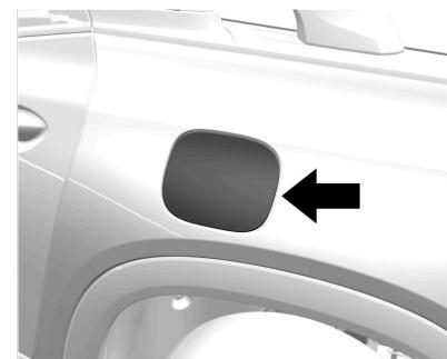
El tapón del tanque de combustible está detrás de una puerita eléctrica, del lado del conductor.
