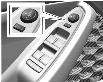
Si está equipado, el mando de los retrovisores eléctricos está situado en el revestimiento de la puerta, al lado del conductor.
