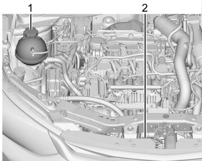
**Se muestra el tanque de compensación del refrigerante para motor turbo; los demás son similares**
