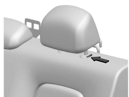
Para bajar el apoyacabezas, presione el botón en la parte superior del respaldo y empuje el apoyacabezas hacia abajo.
