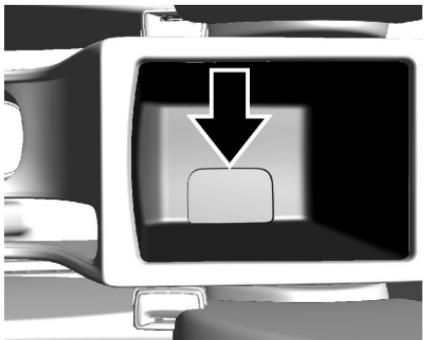
1. Coloque la llave no remota o el transmisor en la consola central o en el apoyabrazos. Las posiciones correctas se muestran en las figuras.
