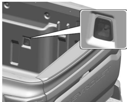
Si está equipada, la luz de carga exterior está ubicada en el panel lateral interior y su función es la de iluminar el área de carga.
