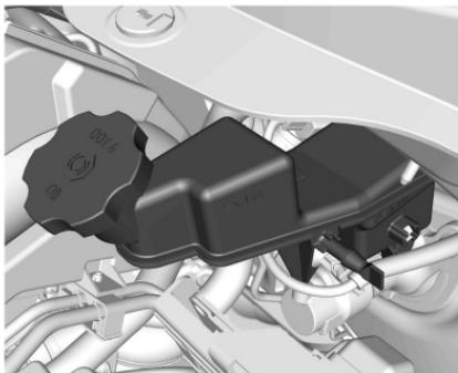
El nivel del líquido de frenos debe estar entre las marcas **MIN** y **MAX**.
