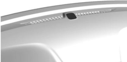
El vehículo tiene un sensor de luz situado en la parte superior del tablero de instrumentos. No cubra el sensor.
