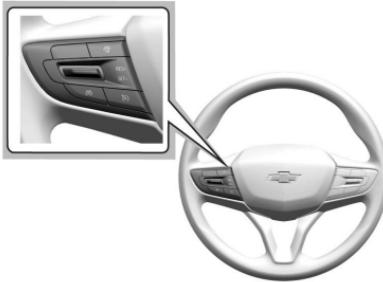
$\textcircled{\text{C}}$  : Pulse para activar y desactivar el sistema de control de velocidad crucero. En el cuadro de instrumentos se enciende un indicador blanco cuando el crucero está activado.
