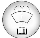
Abra el tapón con que tiene el símbolo del lavaparabrisas. Agregue líquido del lavaparabrisas hasta que se llene el tanque. Vea la ubicación del depósito en *Vista del compartimento del motor* ▷ 158 *Vista del compartimento del motor (Inyección directa)* ▷ 160.
