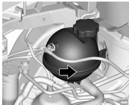
El tanque de compensación del refrigerante está ubicado en el compartimiento del motor, del lado del acompañante. Consulte *Vista del compartimiento del motor* ▷ 158 *Vista del compartimiento del motor (Inyección directa)* ▷ 160.
