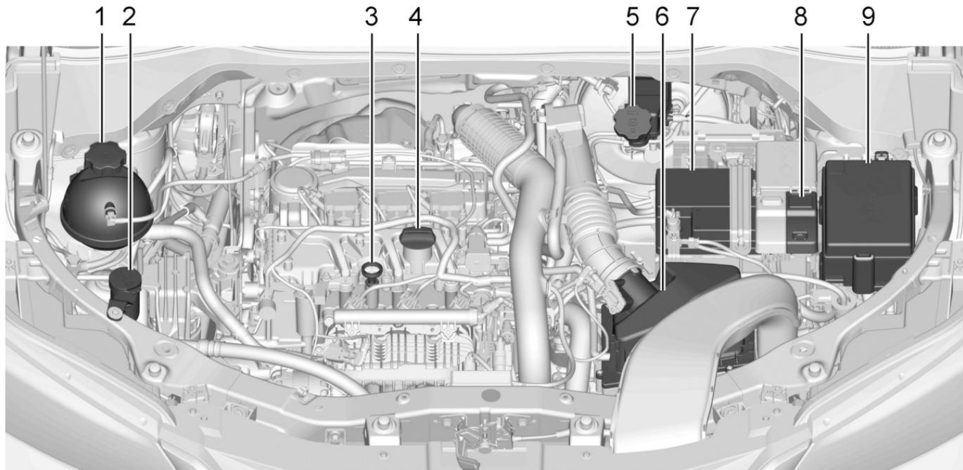
1. Depósito del refrigerante del motor.
