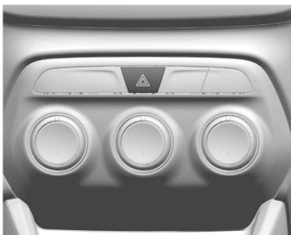
▲ : Pulse ▲ para hacer destellar las luces de giro delanteras, traseras y laterales. Presíñelo nuevamente para apagar las balizas.
