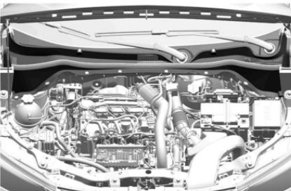
La entrada de aire en el compartimento del motor, delante del parabrisas, debe estar libre para permitir la entrada de aire. Retire cualquier resto de hojas, suciedad o nieve.
