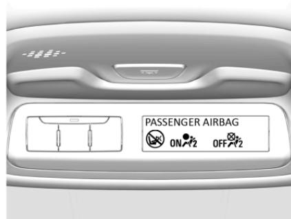
Siempre que el testigo de control **ON
