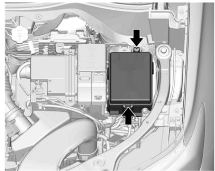
La caja de fusibles está en la parte delantera izquierda del compartimento del motor.
