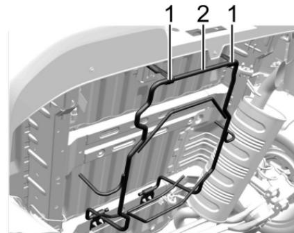
Examine visualmente la jaula y los ganchos para asegurarse de que esté correctamente colocada. Cuando está completamente
