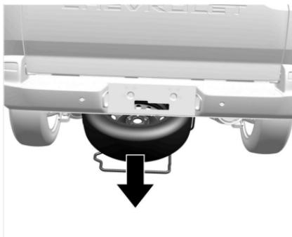
7. Levante levemente la jaula del neumático de auxilio y desenclave los extremos de ambos ganchos.
