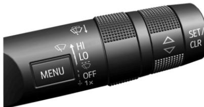
Con el encendido en contacto o en ACC/ACCESORY (ACCESORIO), mueva la palanca del limpiaparabrisas para seleccionar la velocidad del mismo.
