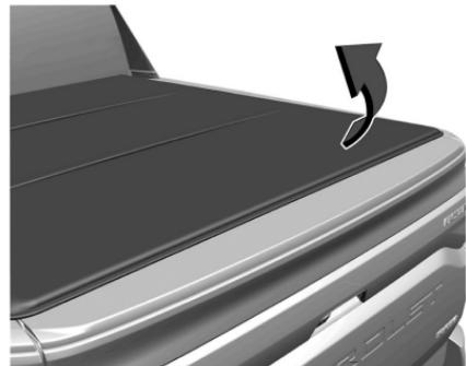
2. Tire de las manijas para desbloquear la capota, de manera que pueda usar el compartimiento de carga.
