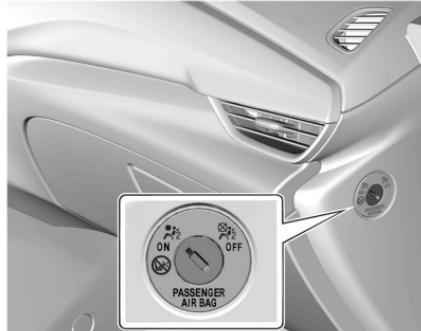
El sistema del airbag del acompañante se puede desactivar mediante una cerradura del costado del tablero de instrumentos, visible cuando se abre la puerta del acompañante.
