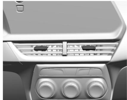
Use las aletas de las rejillas de las salidas de aire para cambiar la dirección del flujo de aire.
