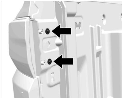
2. Extraiga los dos tornillos que fijan el conjunto de luz trasera a la carrocería del vehículo.
