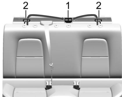
La correa superior se guía a través de los lazos (2) al anclaje de fijación superior (1). Asegúrese de leer las siguientes instrucciones para instalar correctamente un asiento para niños usando estos lazos y anclaje.
