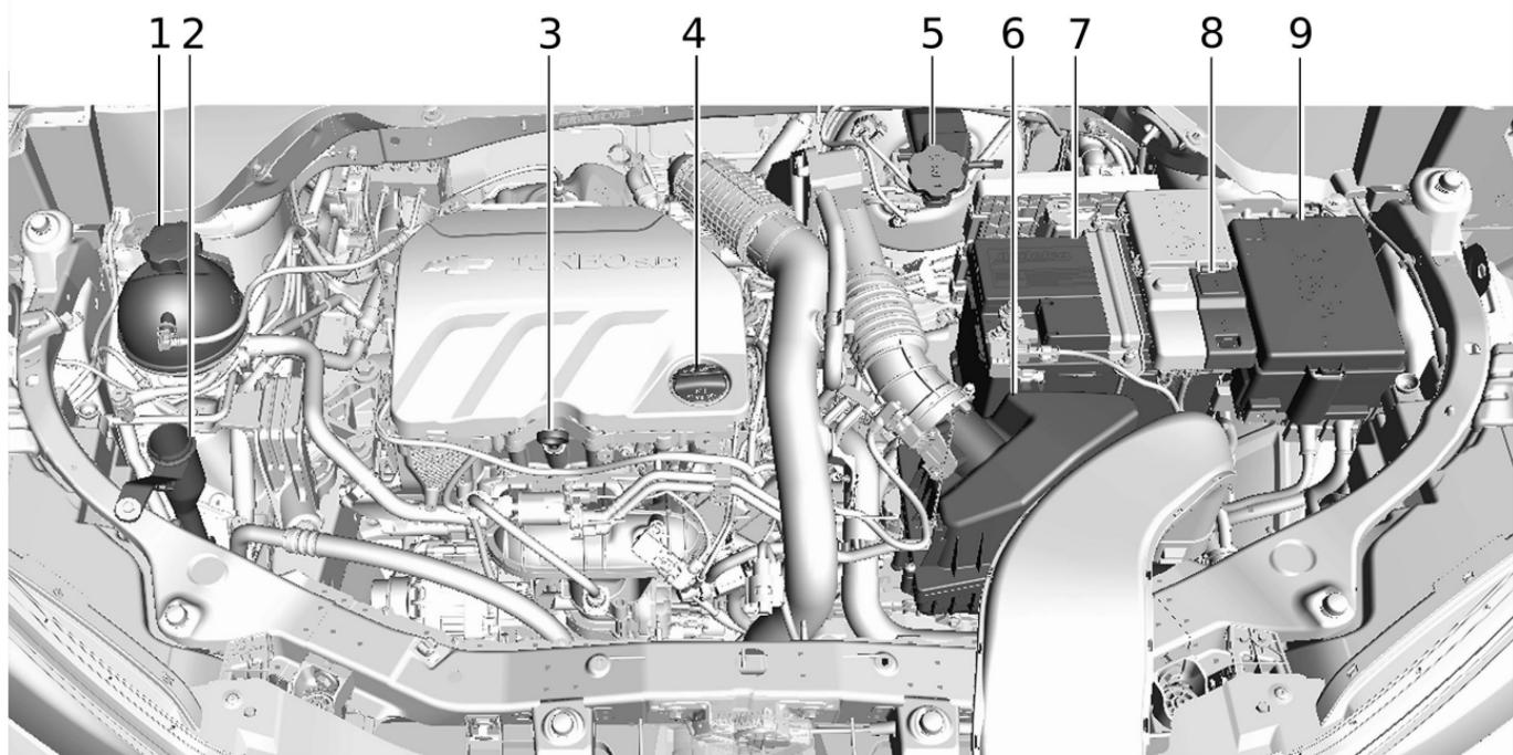
1. Depósito del refrigerante del motor.
