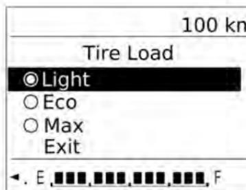
Para establecer la carga de los neumáticos en el menú del Centro de información para el conductor (DIC), detenga el vehículo y aplique el freno de estacionamiento. En los vehículos con transmisión automática, coloque la palanca de cambios en P (Estacionamiento).
