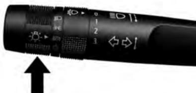
El control de las luces exteriores se encuentra en la palanca de las luces de giro.
