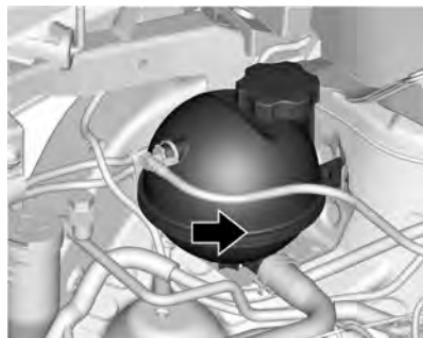
El tanque de compensación del refrigerante está ubicado en el compartimiento del motor, del lado del acompañante.
