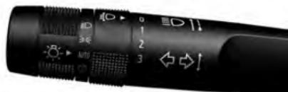
☰ : Con los faros encendidos, para encender la luz alta, empuje la palanca de las luces de giro hacia adelante y suéltela.
