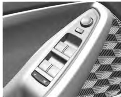
Pulse el interruptor para desactivar los levantavidrios eléctricos traseros. Para activarlos, pulse de nuevo .
