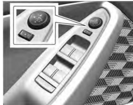
Si está equipado, el mando de los retrovisores eléctricos está situado en el revestimiento de la puerta, al lado del conductor.
