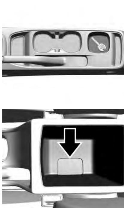
1. Coloque la llave no remota o el transmisor en la consola central o en el apoyabrazos. Las posiciones correctas se muestran en las figuras.
