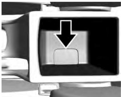
Coloque la llave no remota o la llave electrónica en la cavidad de la consola central o en el apoyabrazos. En las figuras se muestran las posiciones correctas.
