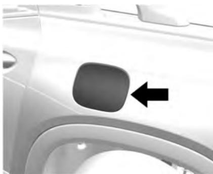
El tapón del tanque de combustible está detrás de una puertita eléctrica, del lado del conductor.
