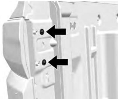
2. Extraiga los dos tornillos que fijan el conjunto de luz trasera a la carrocería del vehículo.
