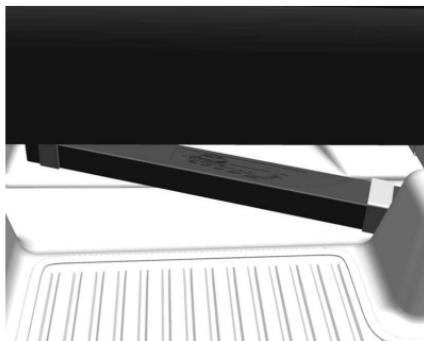
El triángulo de emergencia se guarda debajo del asiento del acompañante delantero.
