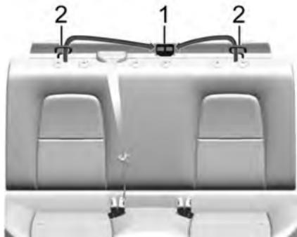
La correa superior se guía a través de los lazos (2) al anclaje de fijación superior (1). Asegúrese de leer las siguientes instrucciones para instalar correctamente un asiento para niños usando estos lazos y anclaje.
