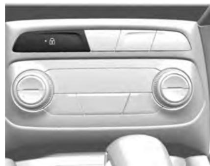
La luz testigo integrada al interruptor del bloqueo de las puertas indica el estado del sistema:
