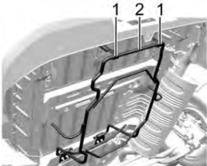
Examine visualmente la jaula y los ganchos para asegurarse de que esté correctamente colocada. Cuando está completamente colocada, la manija (2) del soporte del neumático de auxilio debería estar apenas por encima del borde inferior del paragolpes trasero. Ambos ganchos (1) deberían estar
