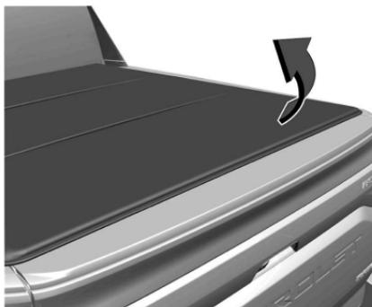
2. Tire de las manijas para desbloquear la capota, de manera que pueda usar el compartimiento de carga.
