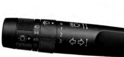
Para señalizar un giro, mueva la palanca hacia arriba o hacia abajo, hasta el tope.
