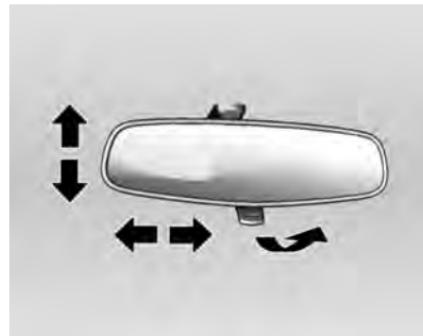
El ajuste se realiza inclinando el espejo hasta una posición adecuada.
