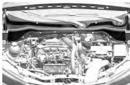
La entrada de aire en el compartimiento del motor, delante del parabrisas, debe estar libre para permitir la entrada de aire. Retire cualquier resto de hojas, suciedad o nieve.
