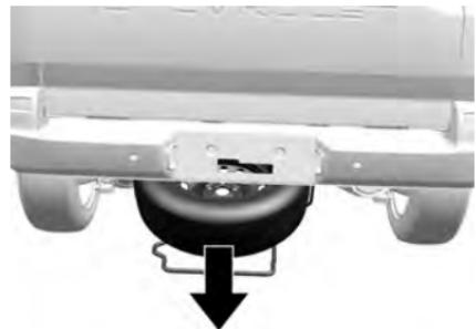
7. Levante levemente la jaula del neumático de auxilio y desenclave los extremos de ambos ganchos.
