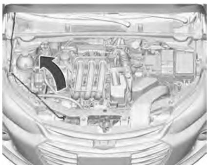
Para mantener el capó del motor abierto, inserte la varilla de apoyo en el orificio correspondiente del capó.
