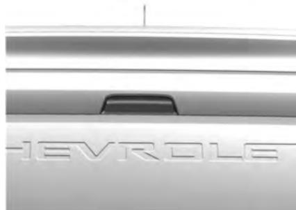
Para abrir la compuerta trasera, el vehículo debe estar apagado o detenido, con la palanca de cambios en P (Estacionamiento), si está equipado.
